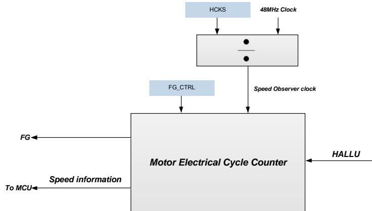
图 19.2.1 电机速度观测器架构
