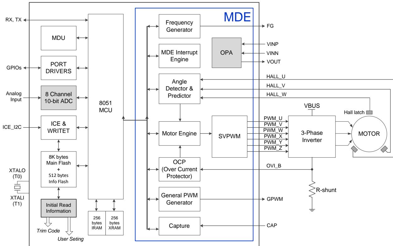
图 2.1 CGH001A BLDC 电机控制器模块图
