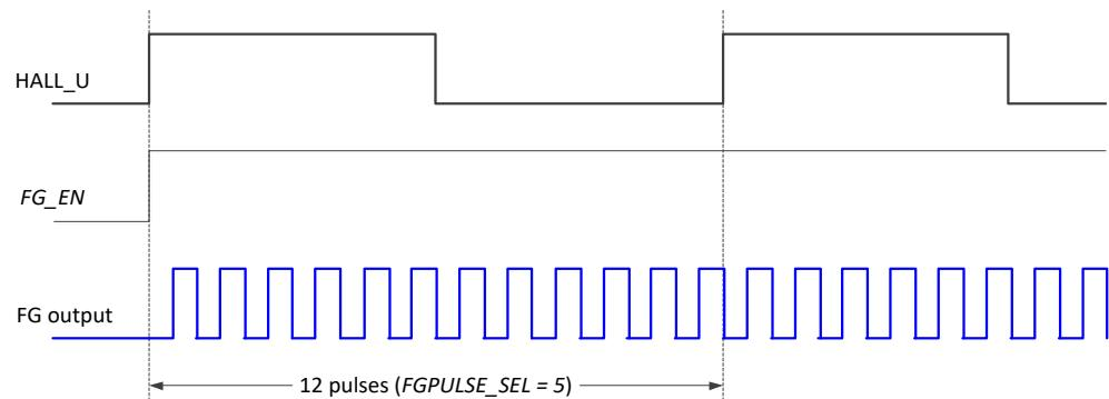
图 19.2.3 当  $FG\_EN=1$ ,  $FG10PT8P=0$ , 并且  $FGPULSE\_SEL=5$  时 FG 输出
