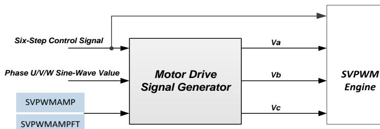
图 19.5.1：电机驱动信号发生器架构
