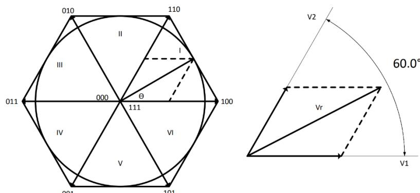
图 19.6.2：正交平面上的 SVPWM 表示
