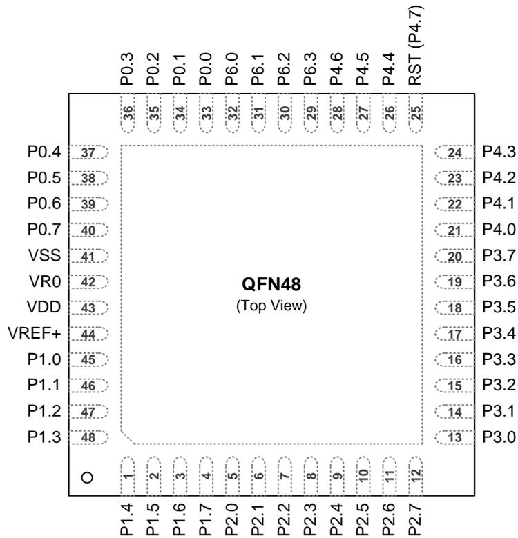
注: MG82F6D64AY48 和 MG82F6D32AY48 有同样的引脚位置图, 但是复用功能不同, 详细请参考“图 4-2. MG82F6D64AD48 LQFP48 顶视图”和“图 4-3. MG82F6D32AD48 LQFP48 顶视图”
