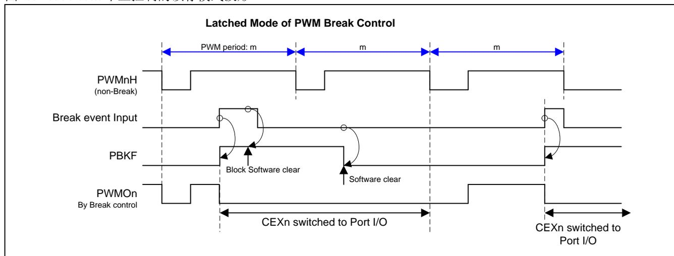
图 17-18. PWM 中止控制的逐周期模式波形
