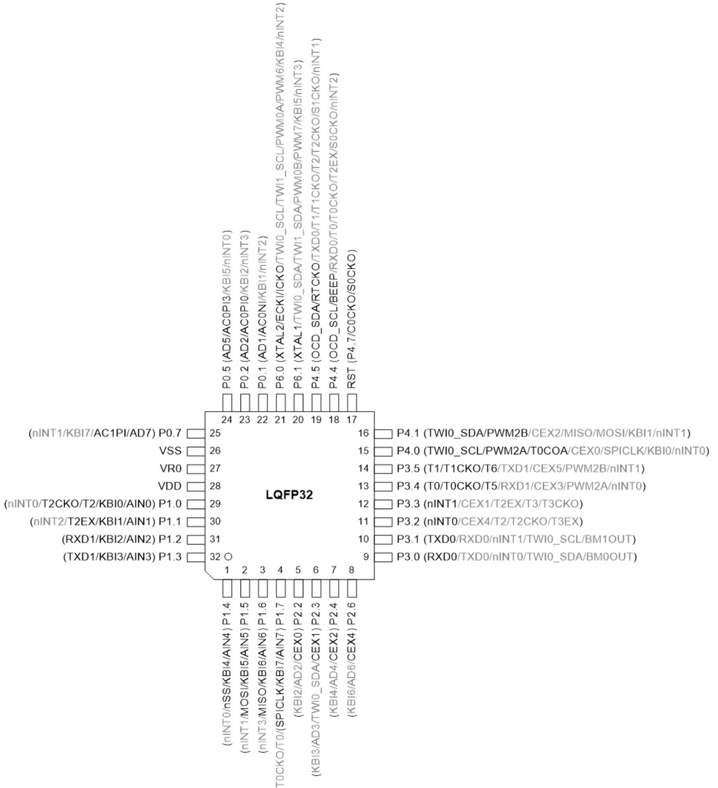
图 4-6. MG82F6D32AZ32 QFN32 顶视图
