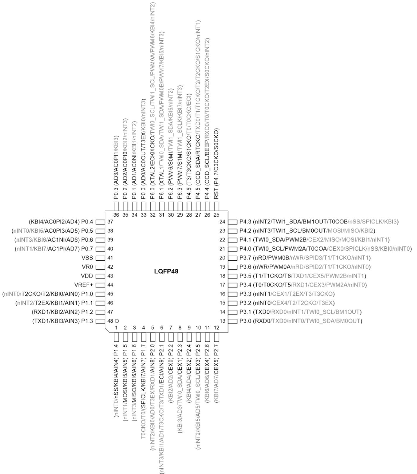
图 4-4. MG82F6D64AY48/MG82F6D32AY48 QFN48 顶视图
