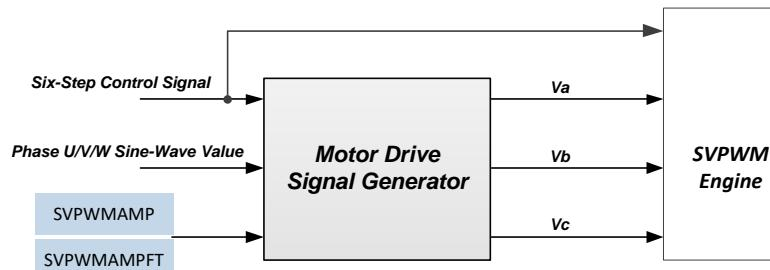
图 19.5.1：电机驱动信号发生器架构
