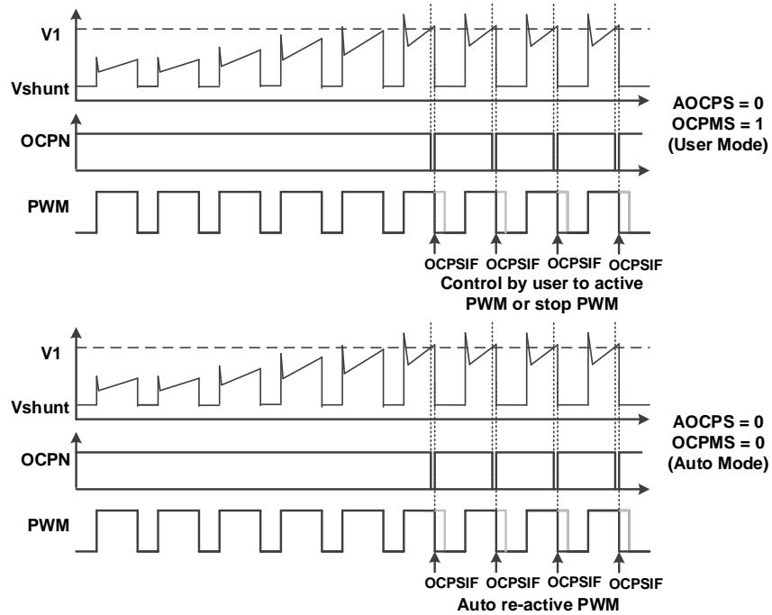
图 19.7.2：数字 OCP 短路发生和 PWM 输出
