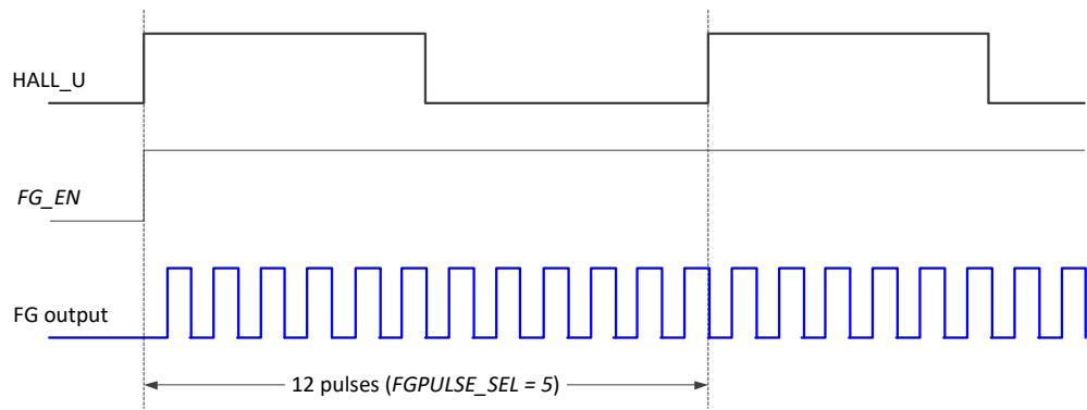
图 19.2.3 当  $FG\_EN=1$ ,  $FG10PT8P=0$ , 并且  $FGPULSE\_SEL=5$  时  $FG$  输出
