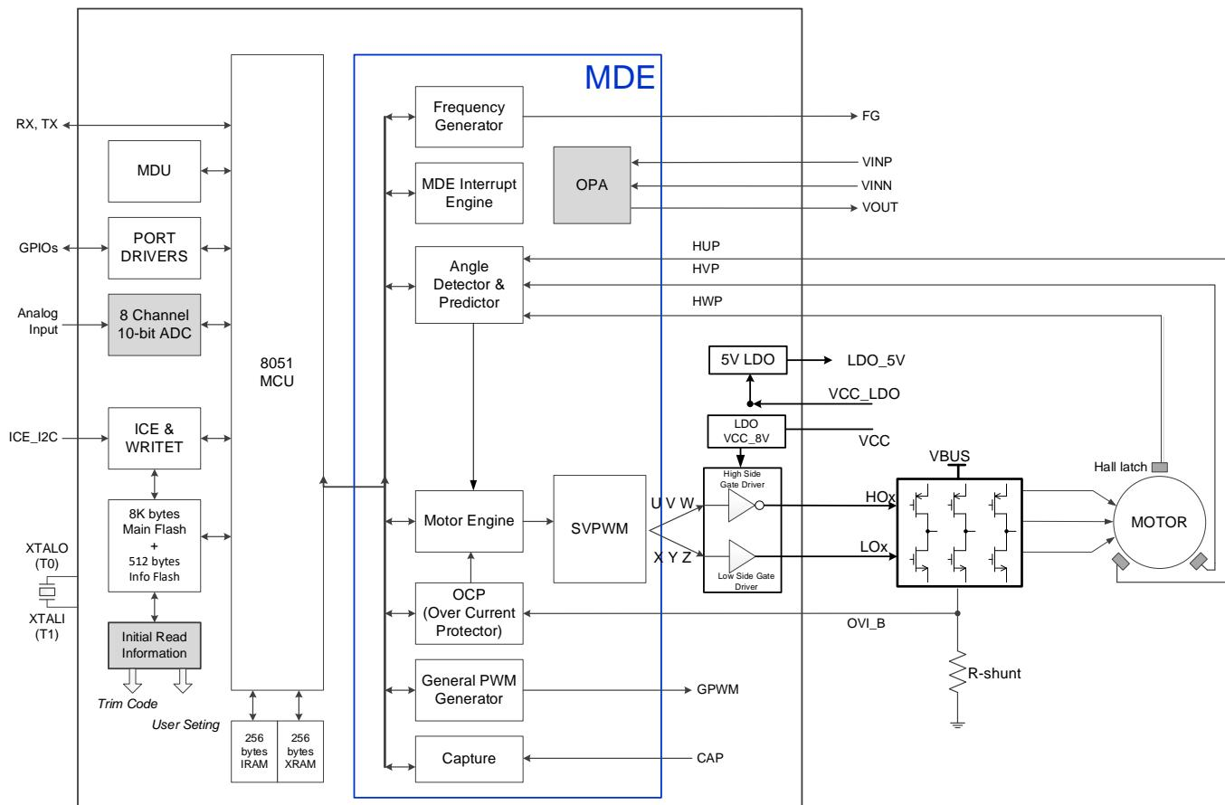
图 2.1 CGH021A BLDC 电机控制器模块图
