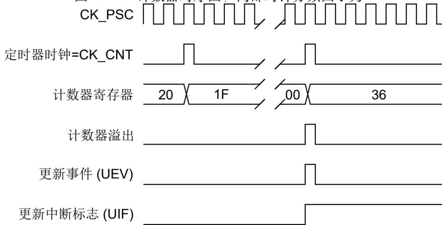
图 16.14: 计数器时序图, 当没有使用重复计数器时的更新事件
