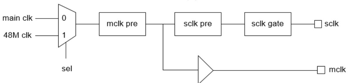
`mclk` 源可以选择 `main clk` 或者 48MHz 时钟，通过 `RCC` 模块的 `MCLKSRC` 配置。`mclk` 的分频器可以通过 `RCC` 模块的 `MCLKPRE` 配置。`sclk` 的分频器可以通过 `RCC` 模块的 `I2SPRE` 配置。详情请参考 `RCC` 模块相关章节。
