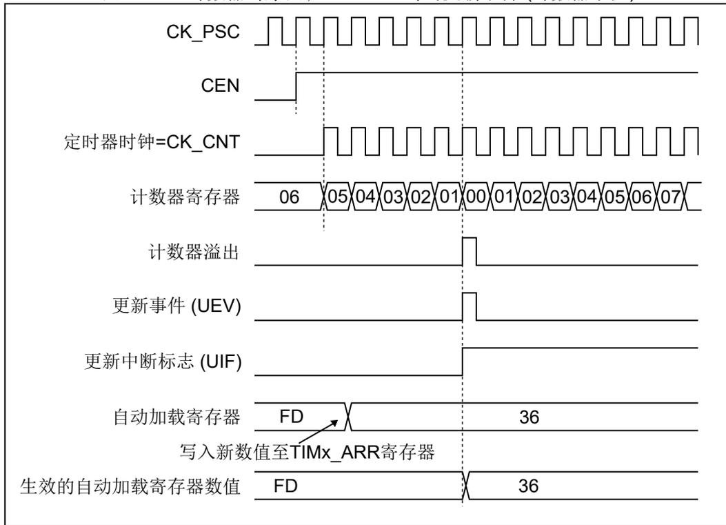
图 17.20: 计数器时序图, ARPE=1 时的更新事件 (计数器溢出)
