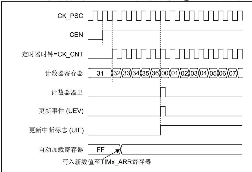
图 16.9: 计数器时序图, 当 ARPE=1 时的更新事件 (预装入 TIMx\_ARR)
