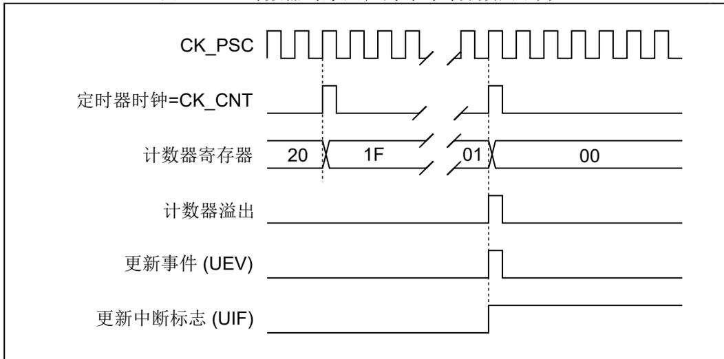
图 16.19: 计数器时序图, ARPE=1 时的更新事件 (计数器下溢)
