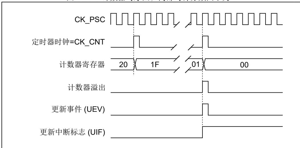
图 17.19: 计数器时序图, ARPE=1 时的更新事件 (计数器下溢)
