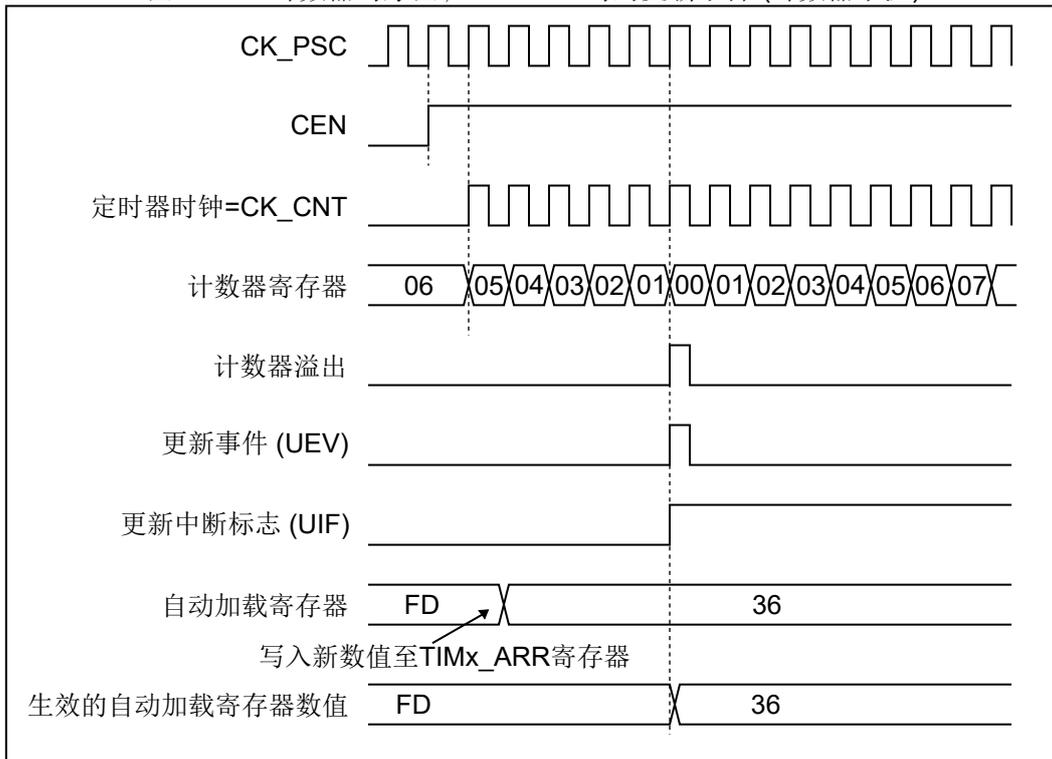
图 16.20: 计数器时序图, ARPE=1 时的更新事件 (计数器溢出)
