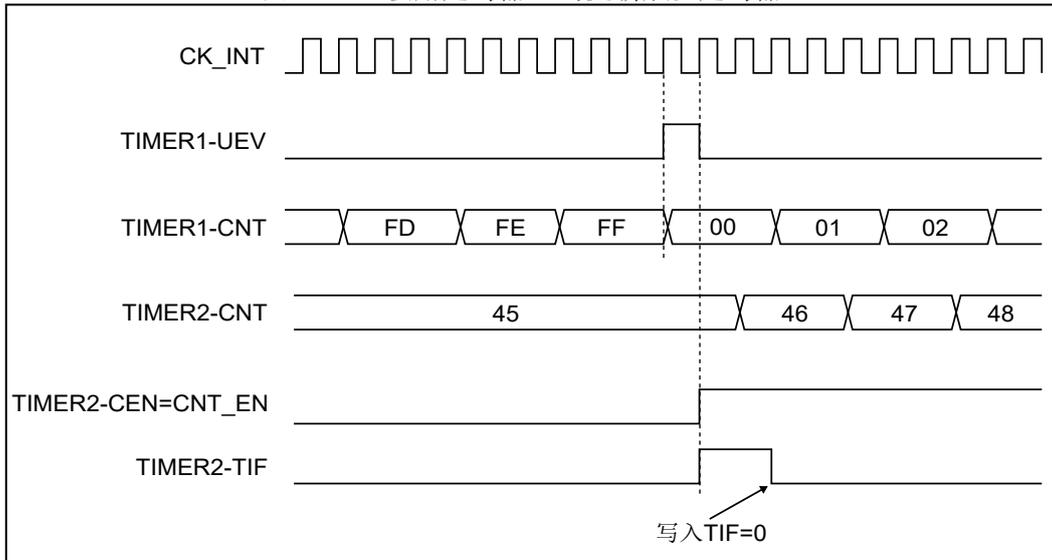
在上一个例子中，可以在启动计数之前初始化两个计数器。图17.40显示在与 0 相同配置情况下，使用触发模式而不是门控模式 (TIM2\_SMCR 寄存器的 SMS=110) 的动作。
