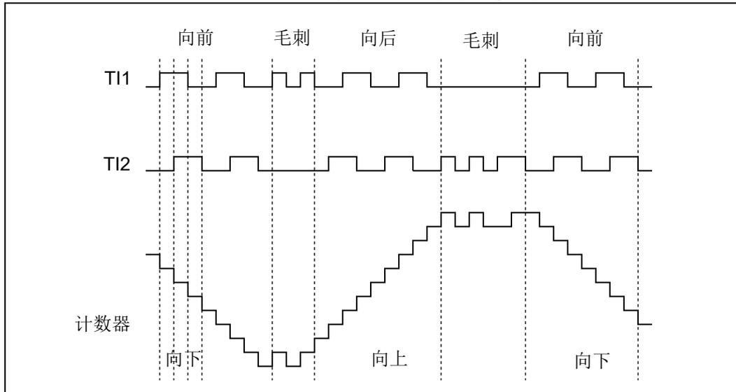
当定时器配置成编码器接口模式时, 提供传感器当前位置的信息。使用第二个配置在捕获模式的定时器, 可以测量两个编码器事件的间隔, 获得动态的信息 (速度, 加速度, 减速度)。指示机械零点的编码器输出可被用做此目的。根据两个事件间的间隔, 可以按照固定的时间读出计数器。如果可能的话, 你可以把计数器的值锁存到第三个输入捕获寄存器 (捕获信号必须是周期的并且可以由另一个定时器产生); 也可以通过一个由实时时钟产生的 DMA 请求来读取它的值。
