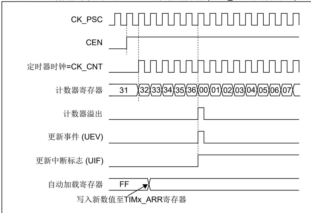
图 17.9: 计数器时序图, 当 ARPE=1 时的更新事件 (预装入 TIMx\_ARR)
