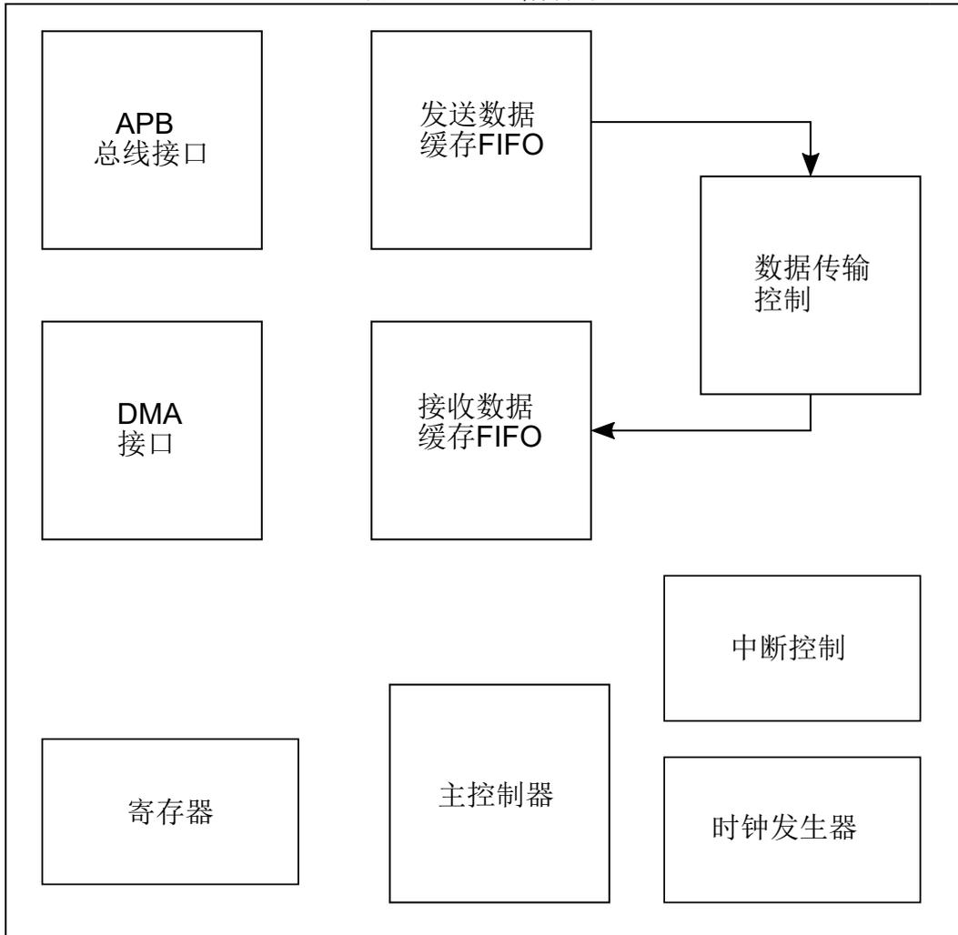
图 23.2: SPI 设备连接图
