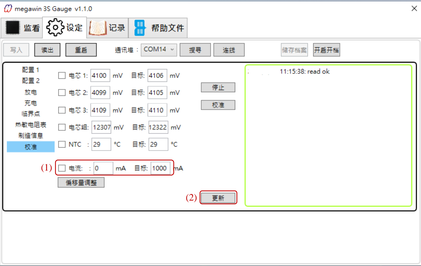
图 5-6 校准页面-电流校准
