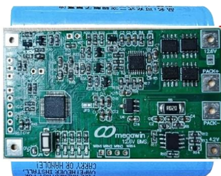
图 2-3 EVM 实际连接电芯图
