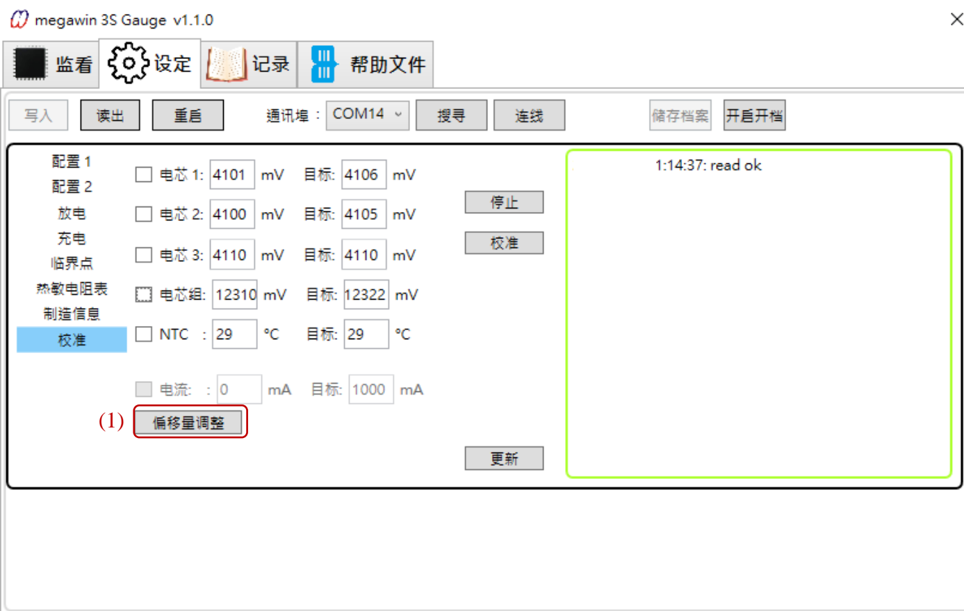
图 5-5 校准页面-电流偏移量
