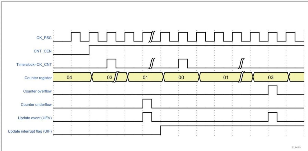
图 9-19 计数器时序图，ARPE = 1 时的更新事件 (计数器下溢)
