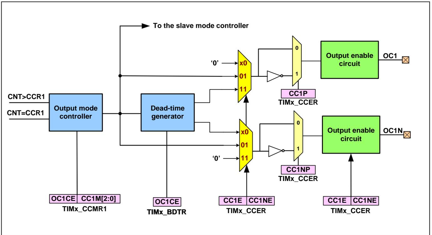
图 9-25 比较通道的输出部分 (通道 4)
