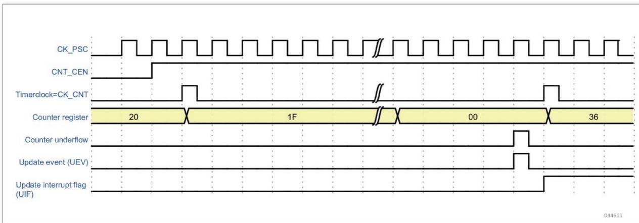
图 9-14 计数器时序图，当没有使用重复计数器时的更新事件
