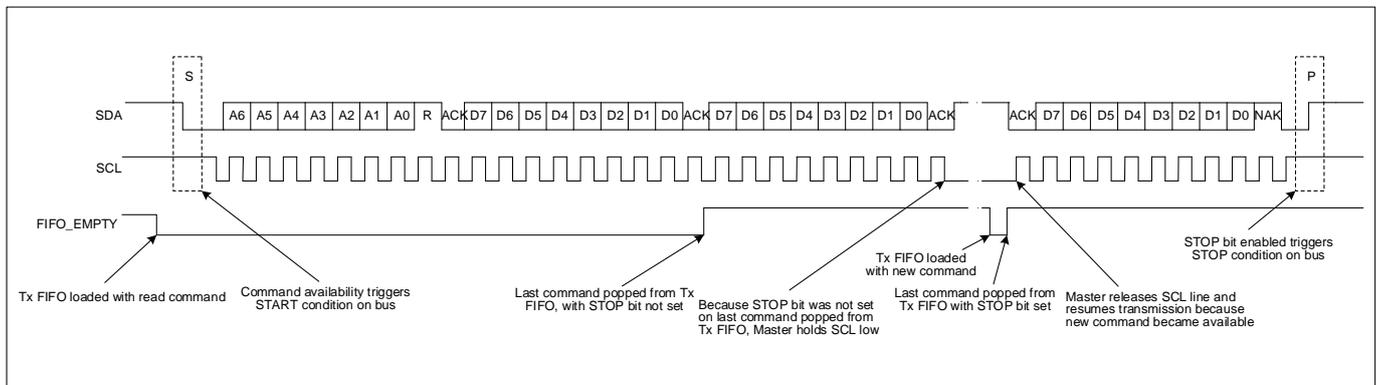
下图描述了 I2C 模块工作在主发送模式下, 发生 RESTART (I2C\_CR.REPEN 为 1) 时的时序。I2C\_CR.REPEN 为 0 时, 则先生成 STOP 再生成 START, 以此代替 RESTART。
