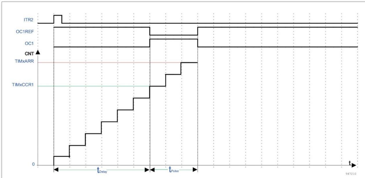
例如，在 ITR2 检测到上升沿，延迟  $t_{DELAY}$  之后，在 OC2 上产生一个长度为  $t_{PULSE}$  的正脉冲。
