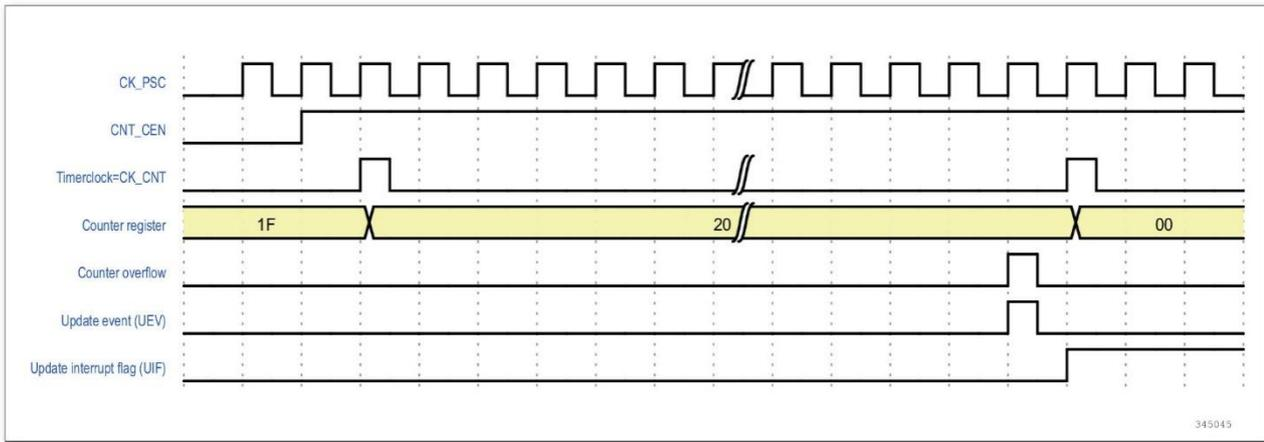
图 9-8 计数器时序图，当 ARPE = 0 时的更新事件(TIMx\_ARR 没有预装入)
