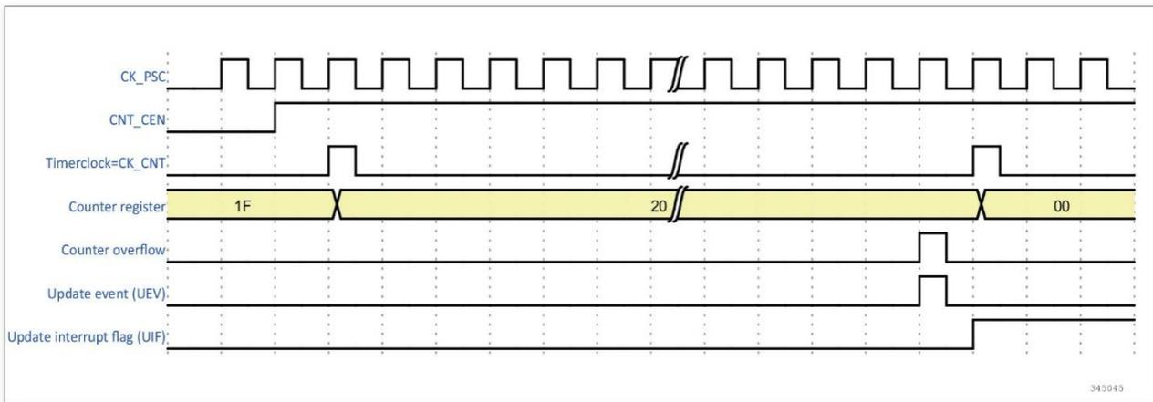
图 11-8 计数器时序图，当 ARPE = 0 时的更新事件 (TIM14\_ARR 没有预重载)
