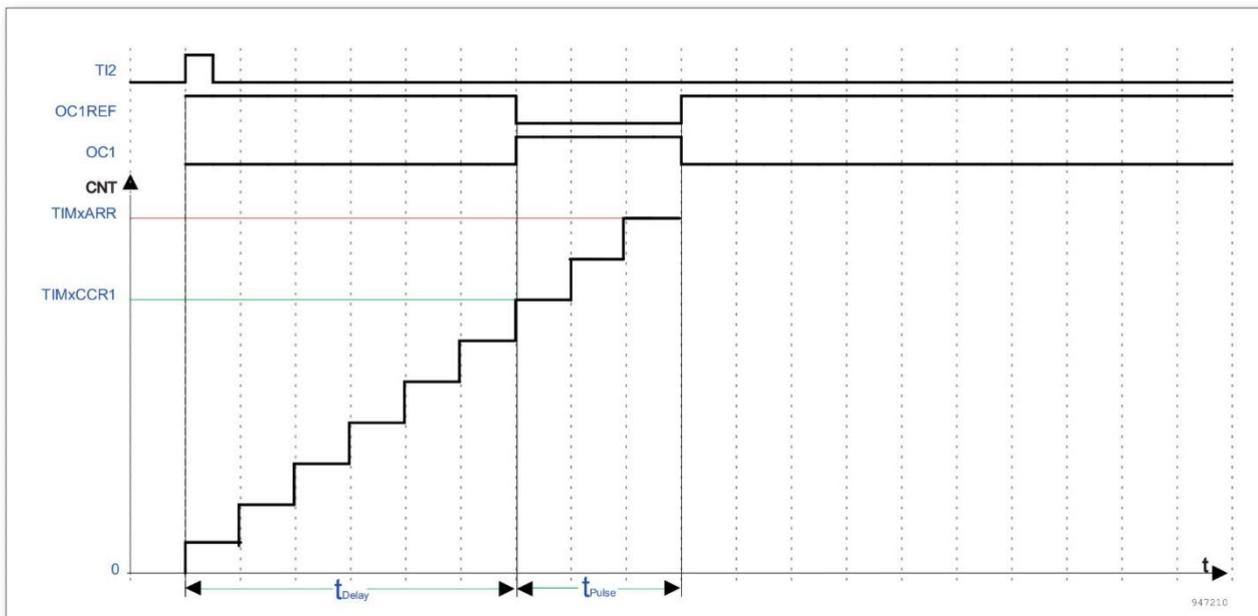
例如，你需要在从 TI2 输入脚上检测到一个上升沿开始，延迟  $t_{DELAY}$  之后，在 OC1 上产生一个长度为  $t_{PULSE}$  的正脉冲。
