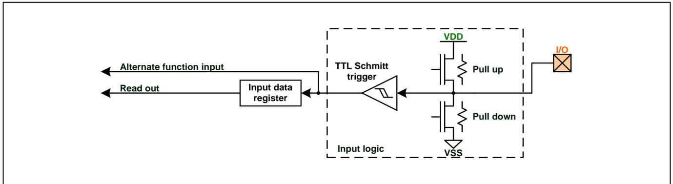
GPIOA 的 PA[0]端口输入上拉参考配置如下：
