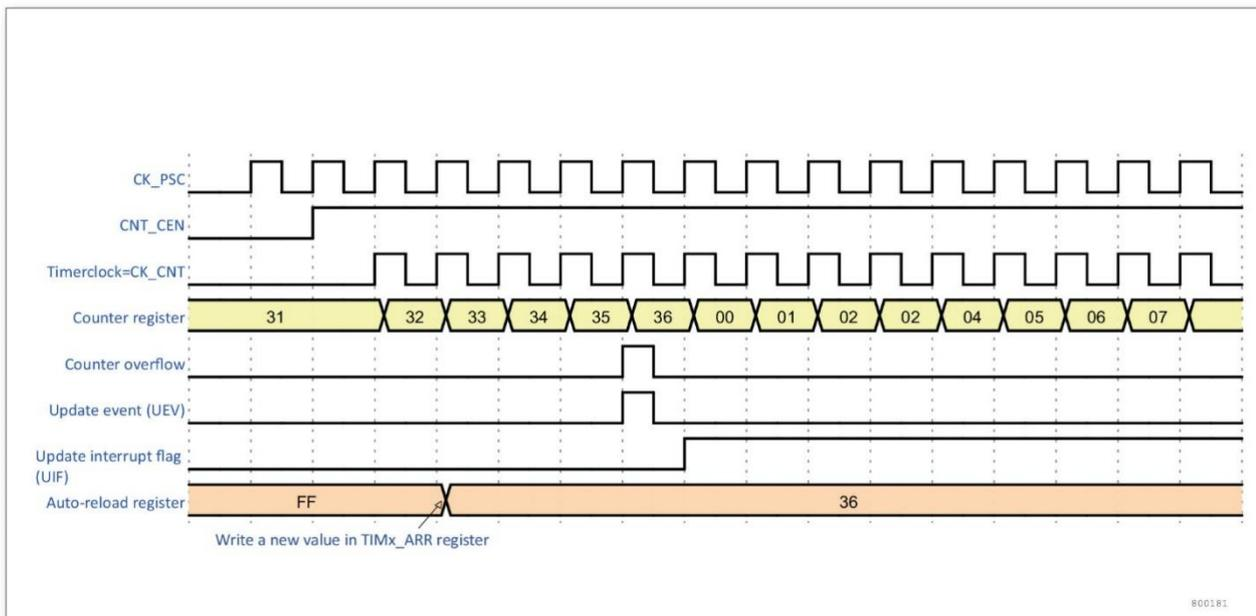
图 11-9 计数器时序图，当 ARPE = 1 时的更新事件 (预重载了 TIM14\_ARR)
