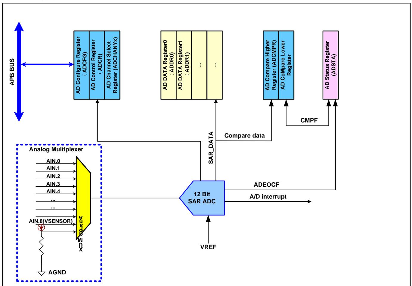
注: V\_SENSOR(内部参考电压) 通道在 ADC 的 AIN8 通道
