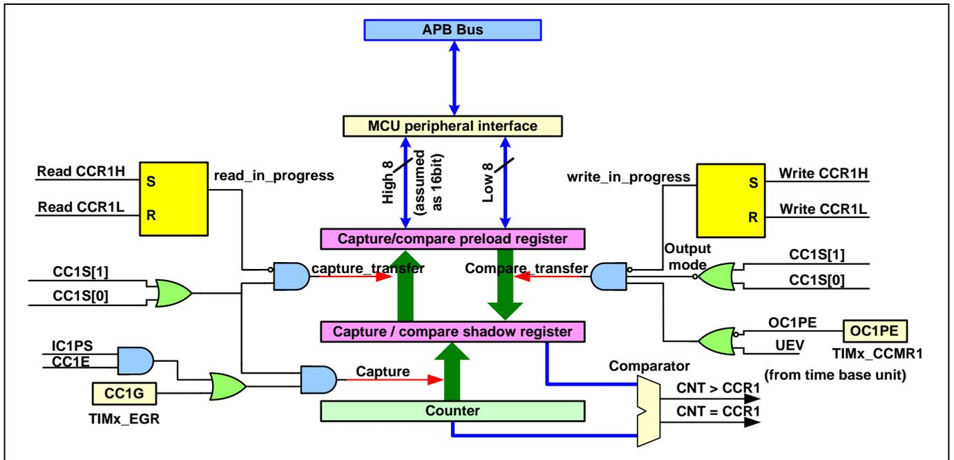
图 10-26 捕获/比较通道的输出部分 (通道 1)
