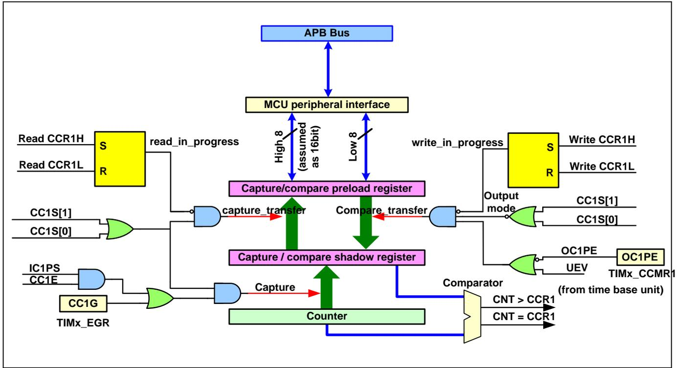
图 11-13 捕获/比较通道的输出部分(通道 1)
