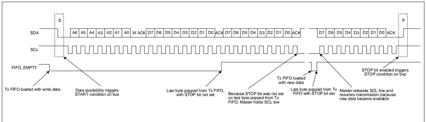
下面的时序图描述了 I2C 模块工作在主接收模式下当 TX FIFO 变为空或产生 STOP 时的行为。
