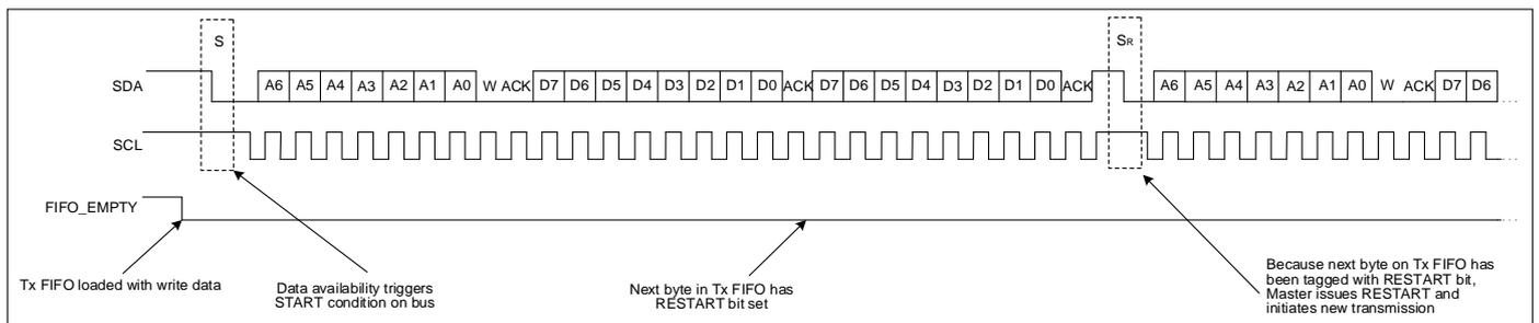
下图描述了 I2C 模块工作在主接收模式下, 发生 RESTART 时的时序。
