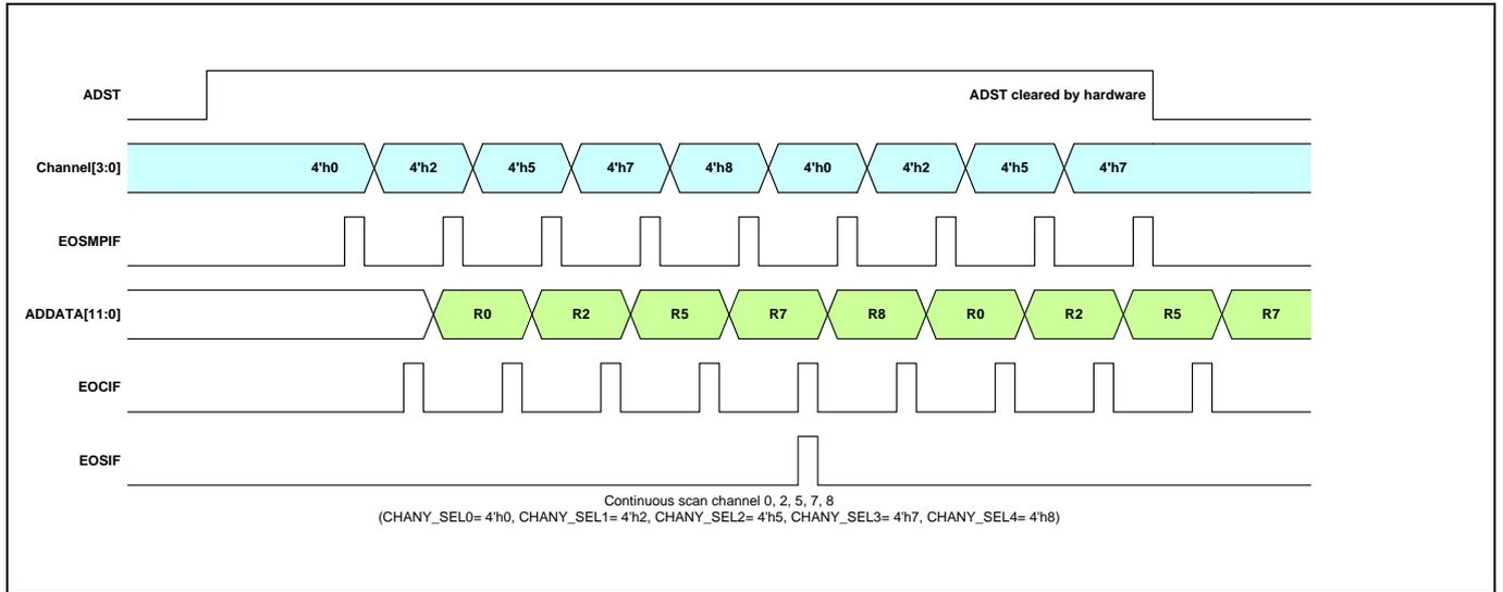
图 8-6 连续扫描模式动态更新配置时序图
