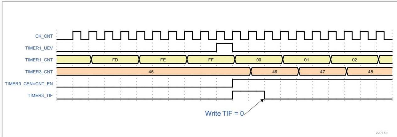
在上一个例子中, 可以在启动计数之前初始化两个计数器。下图显示在相同配置情况下, 使用触发模式而不是门控模式(TIM3\_SMCR 寄存器的 SMS=110)的动作。
