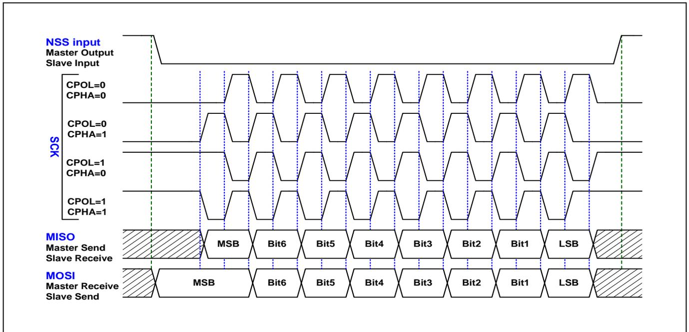
需注意，配置 `SPI_GCTL.NSS=1`，即 NSS 引脚功能由硬件自动控制时，在数据通信完成后硬件将自动拉高此引脚（上图例中所示）；当配置 `SPI_GCTL.NSS=0`，NSS 输出状态则由从机片选寄存器 `SPI_NSS` 的 NSS 位进行控制（需软件切换 NSS 引脚的输出状态）。
