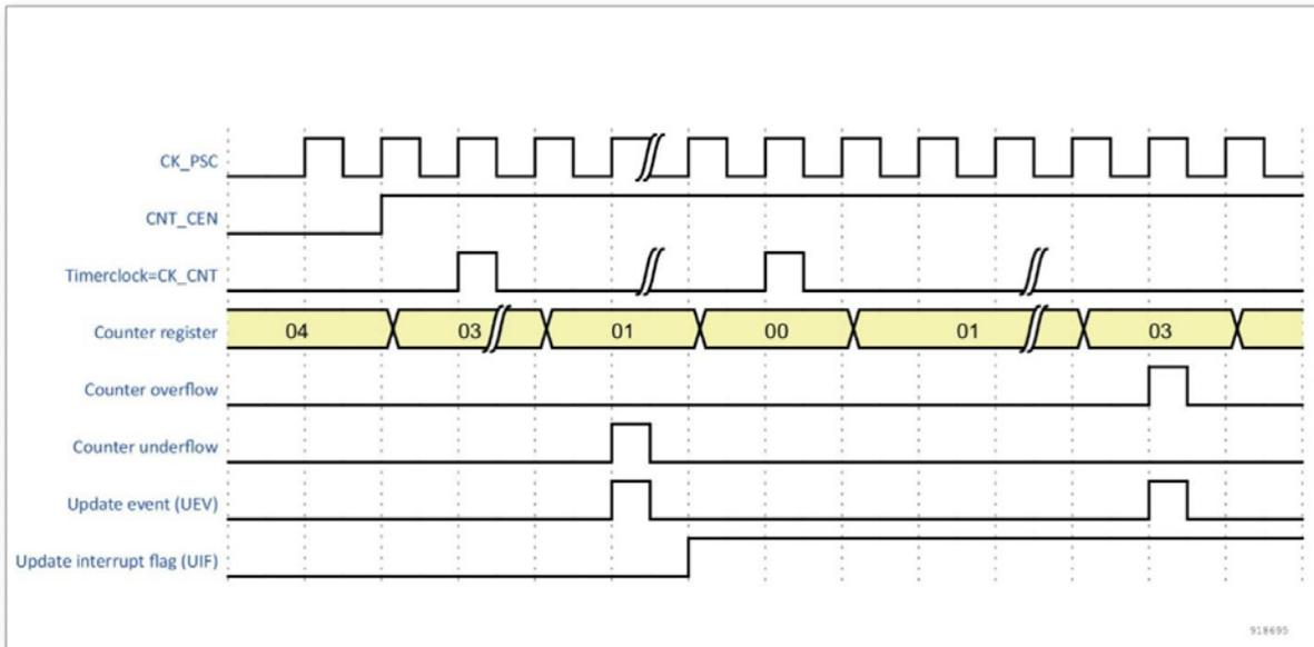
图 10-19 计数器时序图，ARPE = 1 时的更新事件 (计数器下溢)
