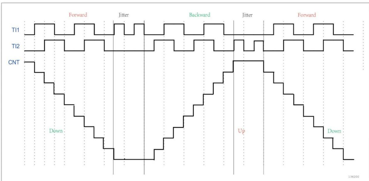
当定时器配置成编码器接口模式时，提供传感器当前位置的信息。使用第二个配置在捕获模式定时器测量两个编码器事件的间隔，可以获得动态的信息 (速度，加速度，减速度)。指示机械零点的编码器输出可被用做此目的。根据两个事件间的间隔，可以按照固定的时间读出计数器。如果可能的话，你可以把计数器的值锁存到第三个输入捕获寄存器 (捕获信号必须是周期的并且可以由另一个定时器产生)。
