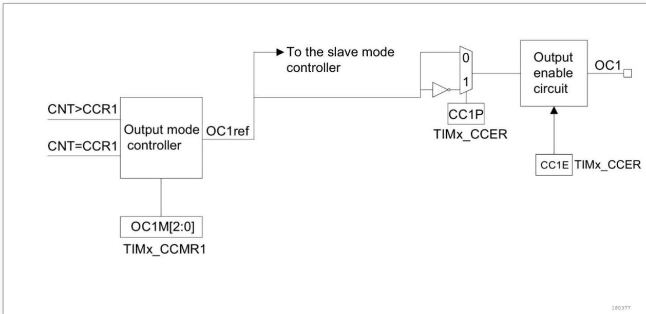
图 11-14 捕获/比较通道的输出部分 (通道 1)
