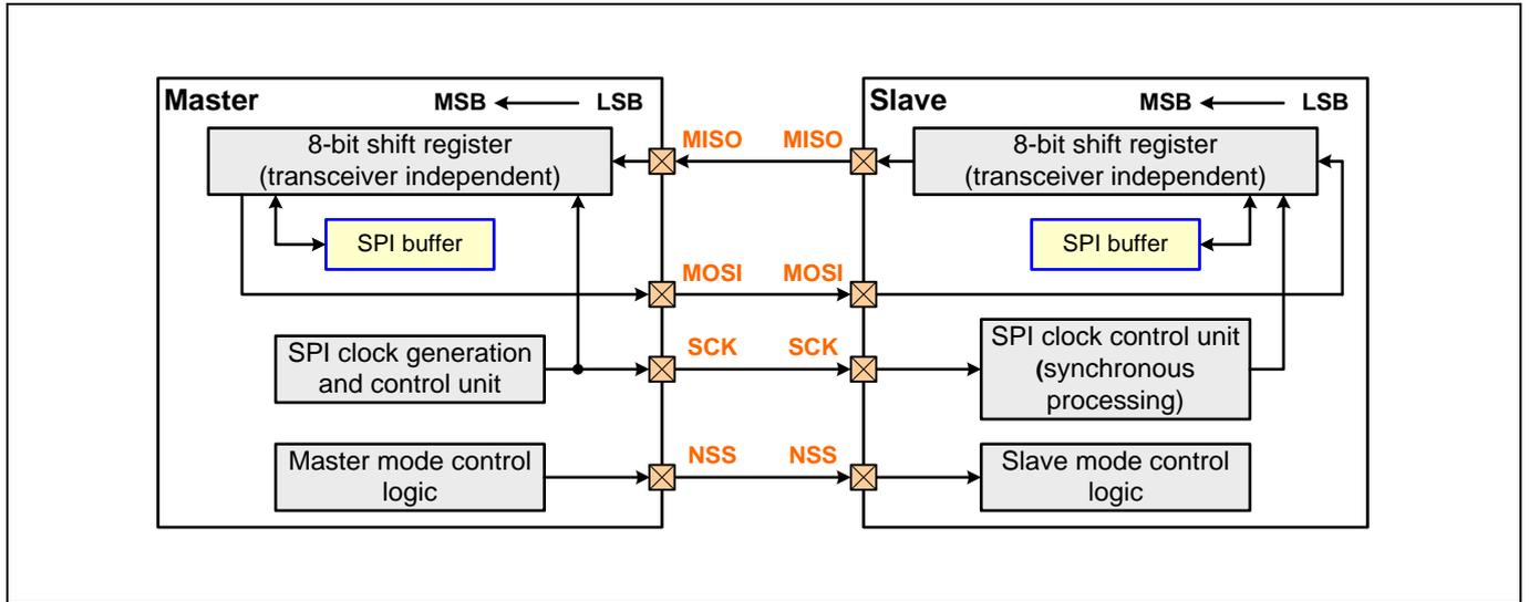
SPI 主、从设备的同名引脚互连，图中示意数据方向为从最高位到最低位的方式串行通信。
