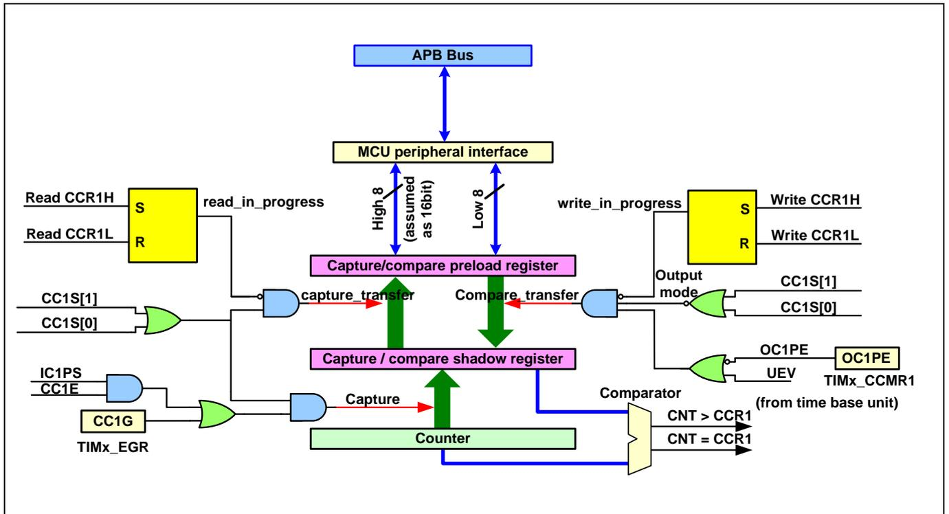
图 9-24 比较通道的输出部分 (通道 1 至 3)
