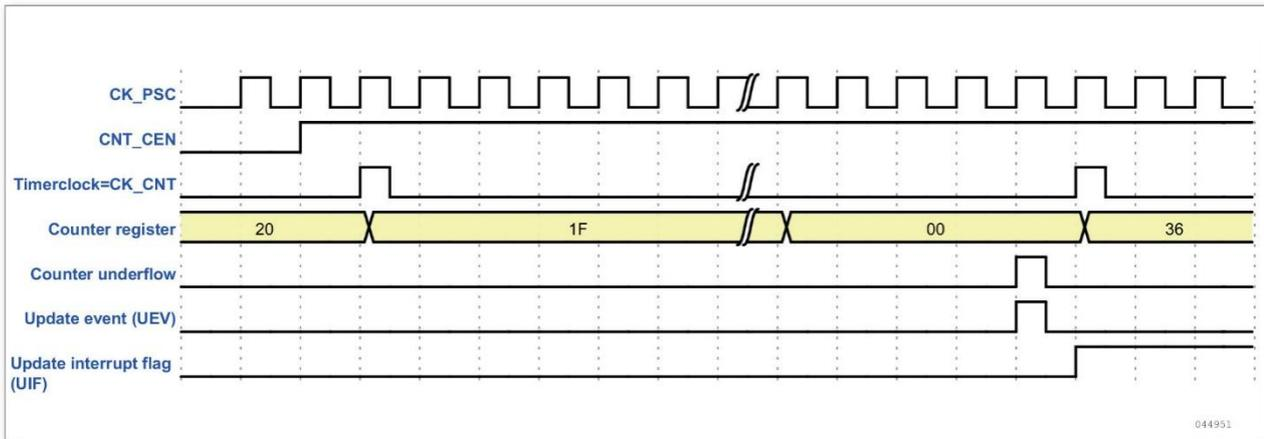
图 10-14 计数器时序图，当没有使用重复计数器时的更新事件
