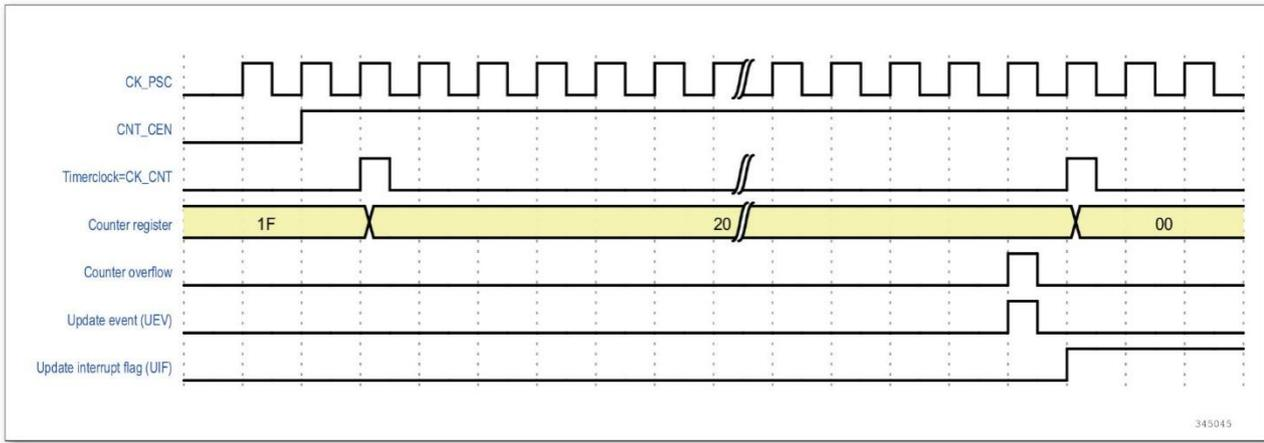
图 10-8 计数器时序图，当 ARPE = 0 时的更新事件 (TIMx\_ARR 没有预装入)
