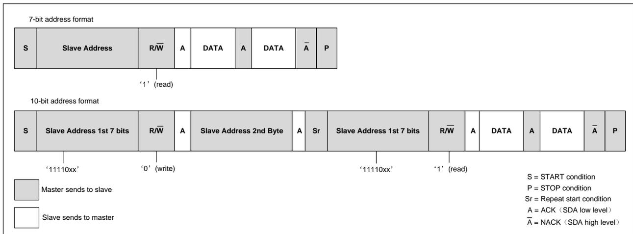
主器件不想因产生停止条件而释放总线时，可以产生一个重复起始条件。重复起始条件与起始条件相同，但重复起始条件在 ACK 后产生。在主模式下，I2C 接口可以使用不同的传输方向与相同的从器件通信。
