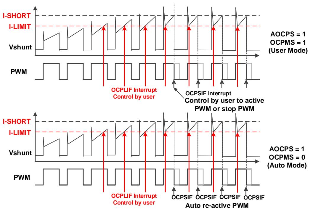
图 19.7.3：模拟 OCP 短路发生和 PWM 输出
