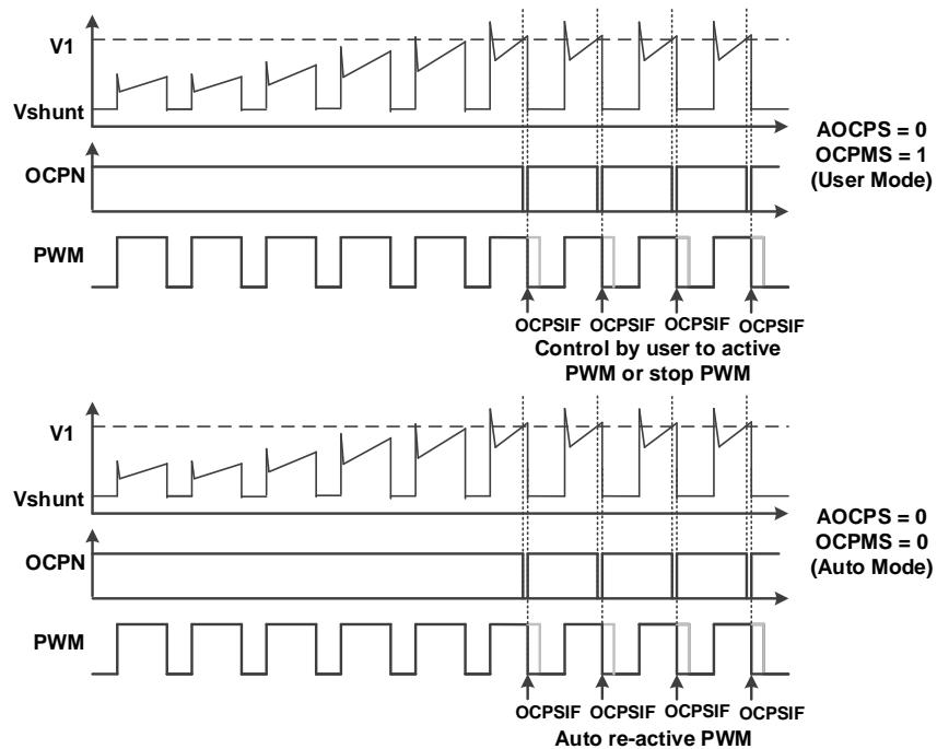
图 19.7.2：数字 OCP 短路发生和 PWM 输出
