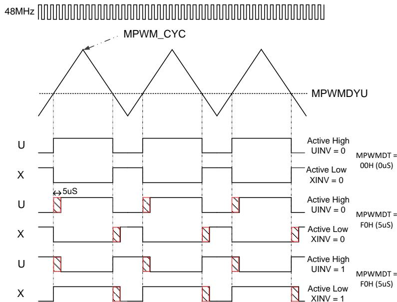
图 19.6.8：带死区时间 PWM 输出和 PWM 模式
