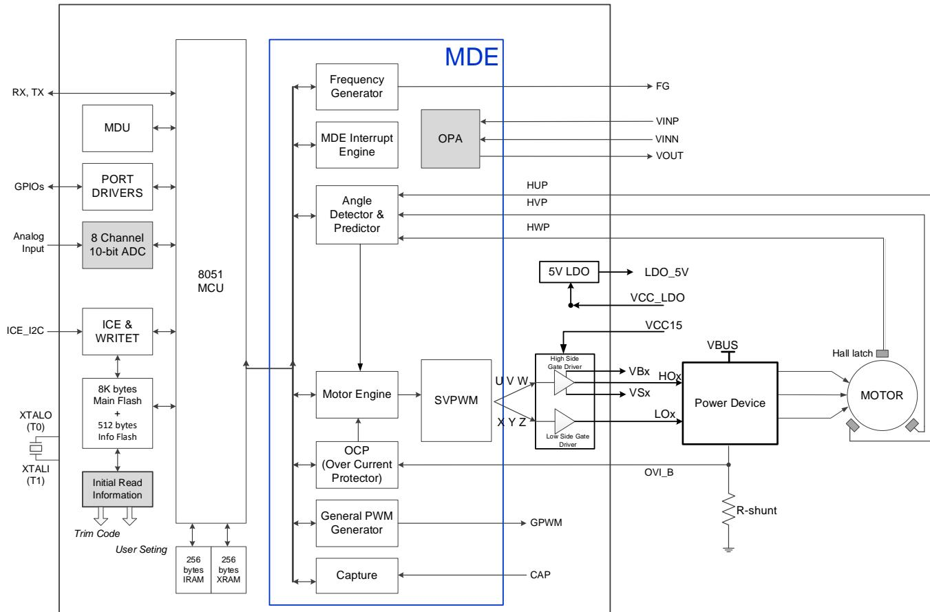
图 2.1 CGH081A BLDC 电机控制器模块图
