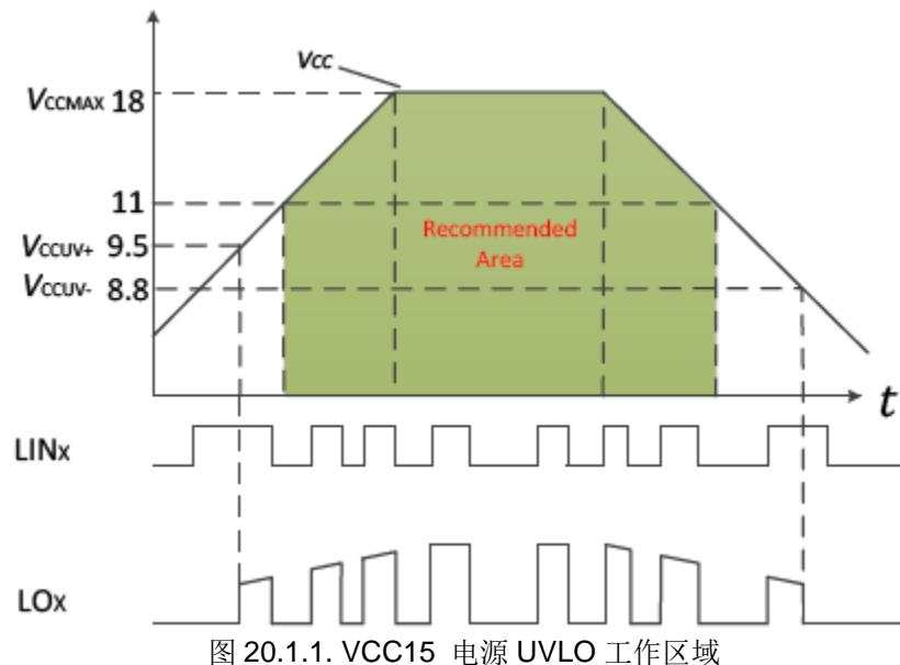
图 20.1.1. VCC15 电源 UVLO 工作区域
