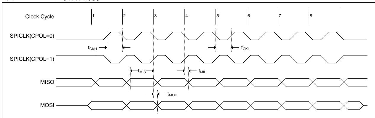
图 28-4. SPI 主机传送波形 CPHA=1
