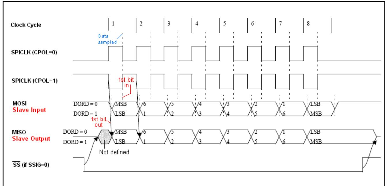
图 18-7 SPI 主机传送格式 (CPHA=0)
