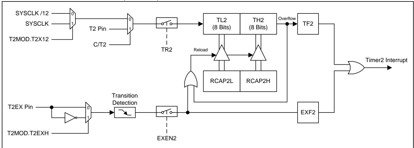
图 15-8 示 DCEN=1，使能定时器 2 向上或向下计数。这种模式下允许 T2EX 引脚控制计数方向。当 T2EX 的引脚为逻辑 1 时定时器 2 向上计数。定时器 2 在 0xFFFFH 时溢出并置位 TF2 标志位，如果中断使能将产生中断。溢出也将引起 RCAP2L 和 RCAP2H 的 16 位值加载到定时器的寄存器 TL2 和 TH2。当 T2EX 的引脚为逻辑 0 时定时器 2 向下计数。当 TL2 和 TH2 和存储在 RCAP2L 和 RCAP2H 的值相等时将产生下溢。下溢将置位 TF2 标志位并将 0xFFFFH 加载到定时器的寄存器 TL2 和 TH2。
