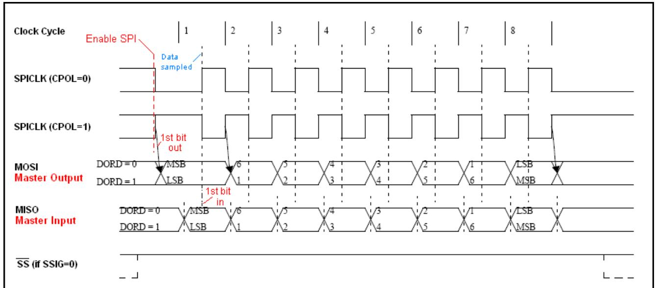
图 18-8 SPI 主机传送格式 (CPHA=1)
