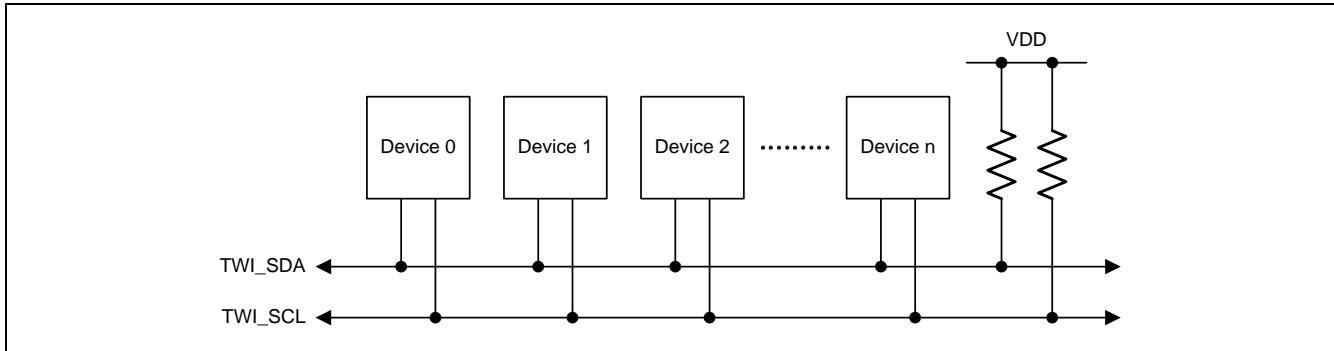
TWSI 总线可以操作在主机或从机也可以是多主机。CPU 通过 SIADR (串行接口从机地址寄存器)、SIDAT (串行接口数据寄存器，用于发送和接收 TWSI 数据)、SICON (串行接口控制寄存器)、SISTA (串行接口状态寄存器) 这四个特殊功能寄存器与 TWSI 相连。TWSI 硬件通过两根数据线与串行总线相连：SDA (串行数据线，P4.1)、SCL (串行时钟线，P4.0)。
