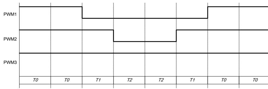
图 25.6.5 : 5 段 SVPWM 输出电压
