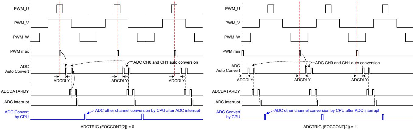
图 16.3.1 : MDE 与 CUP 实现 ADC 转换的时序图
