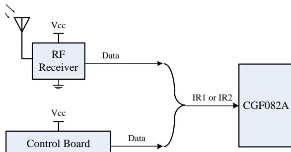
图 23.1 : CGF022A 单线解码的方框图
