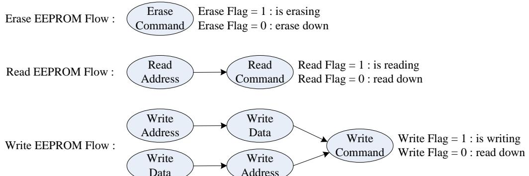
图 17.1 : EEPROM 擦除, 读和写控制流程
