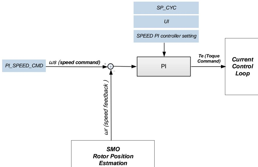
图 25.7.1 : 速度控制环模块框图
