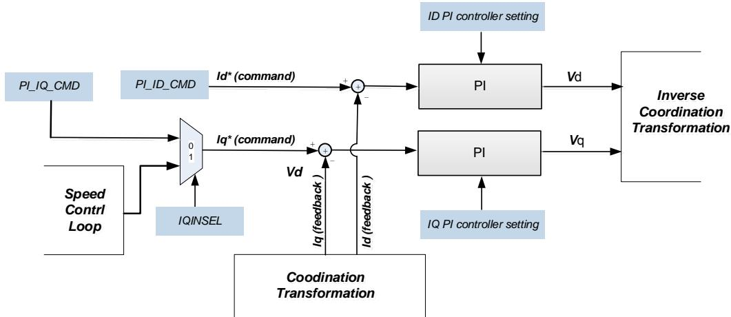
图 25.3.1 : 电流控制环模块框图
