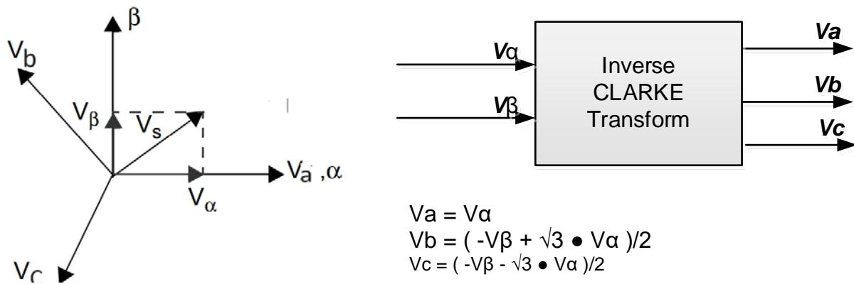
图 25.4.3 : Cleake 逆变换
