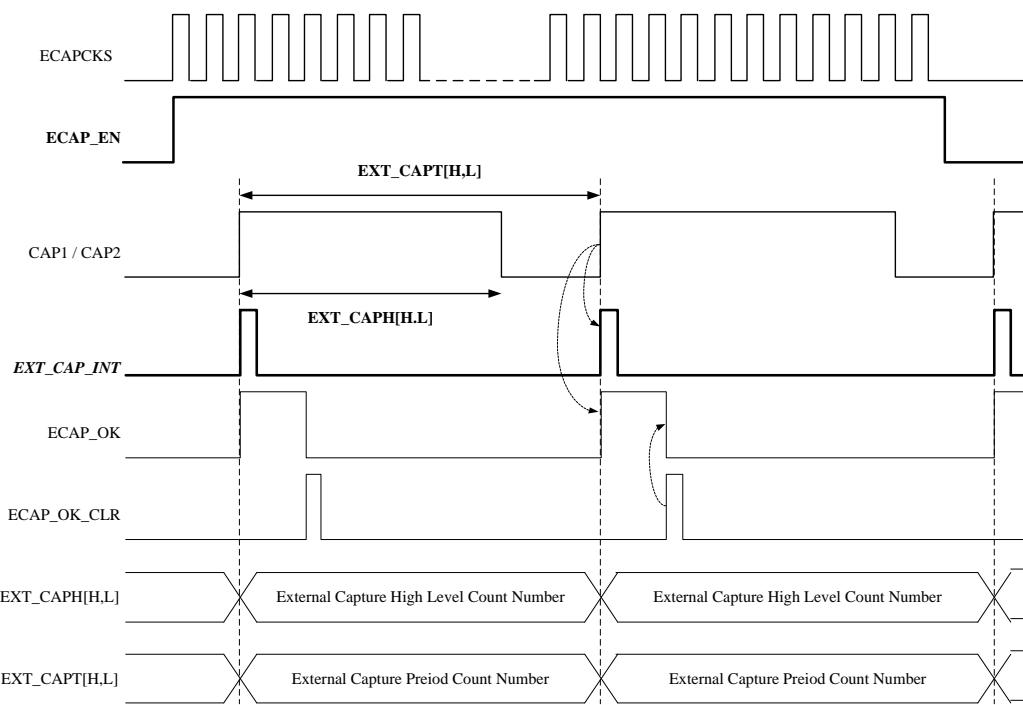
图 19.1.1 : 外部捕获的波形序列
