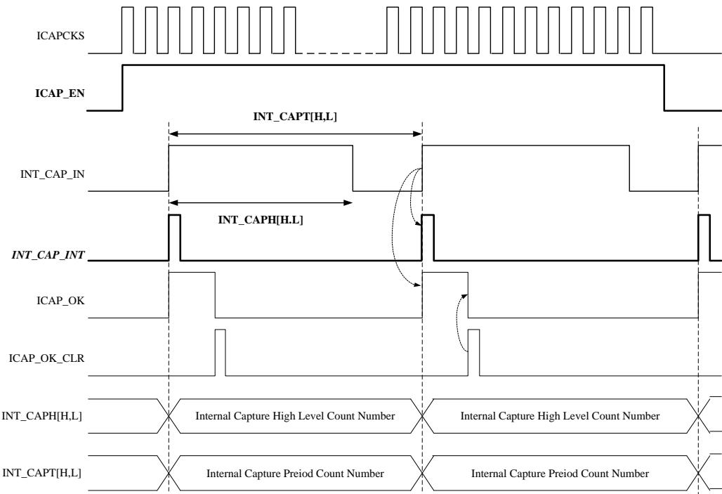
图 19.2.1 : 内部捕获控制波形
