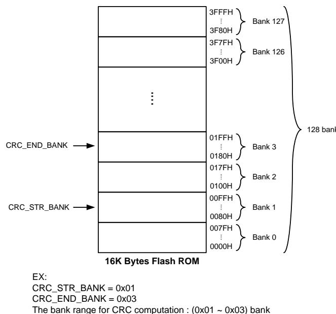
图 21.3 : 用于块 CRC 计算的块分配示例
