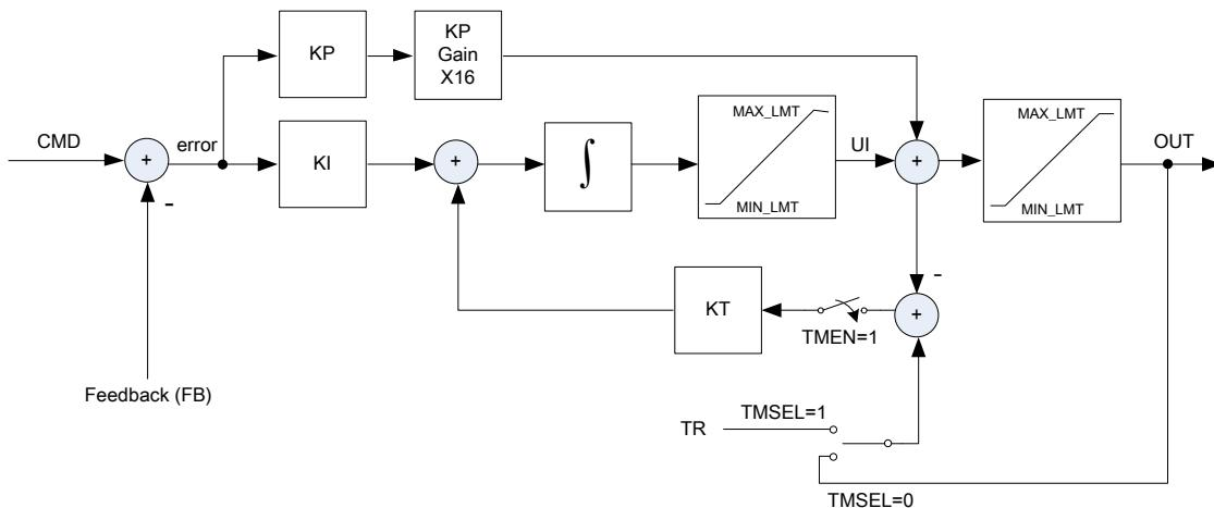
图 25.8.1 : PI 控制器模块框图
