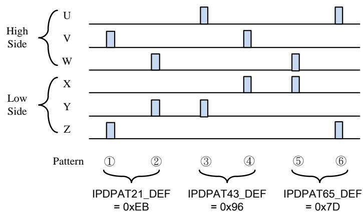
图 25.9.3 : IPD pattern 高低边开启状态初始设置
