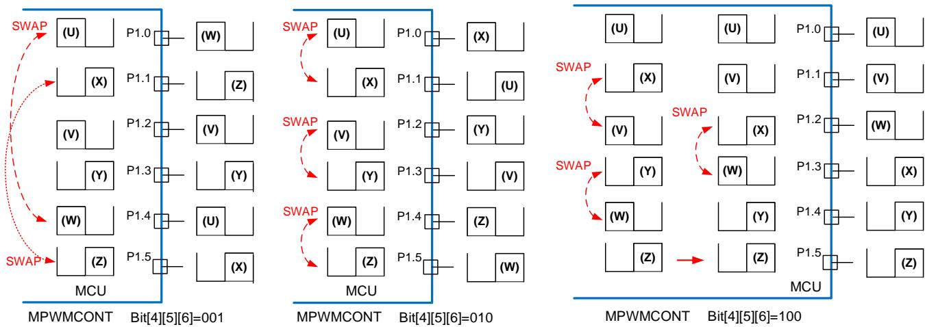
图 25.6.7 : PWM 引脚交换单元架构
