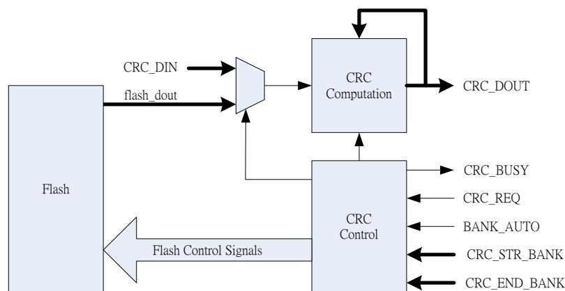
图 21.2 : 字节和 Flash 块 CRC 计算架构
