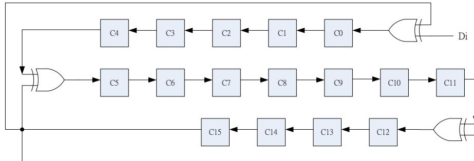
图 21.1 : CRC16-CCITT 的通用 LSRF 体系结构
