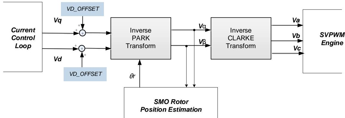
图 17.4.1 : 逆坐标变换模块框图
