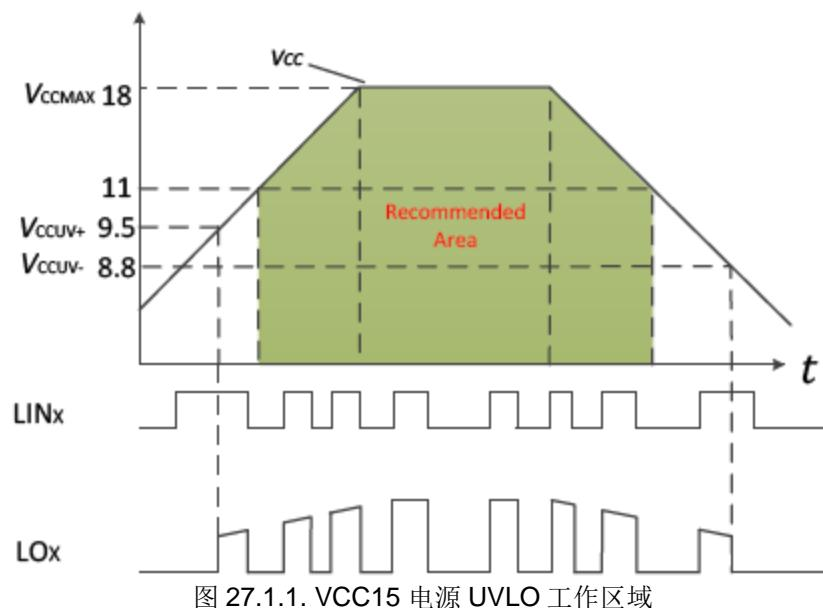
图 27.1.1. VCC15 电源 UVLO 工作区域
