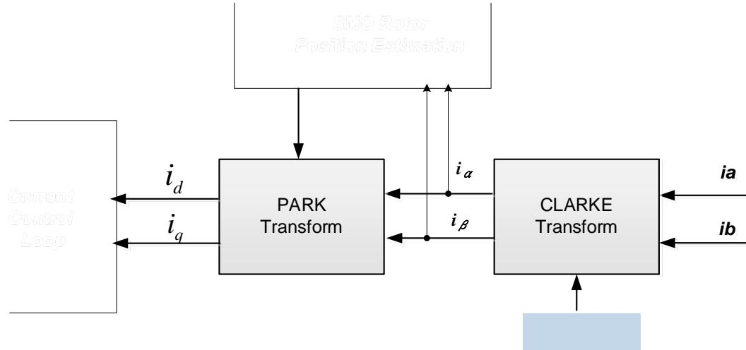
图 25.2.1 : 坐标变换模块架构
