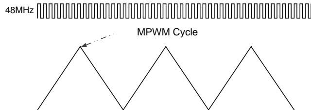
图 25.6.6 : 电机 PWM 向上向下定时器
