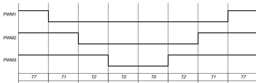
图 25.6.4 : 7 段 SVPWM 输出电压
