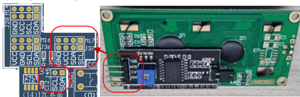
圖 9-7 I 2 C 介面 LCD 顯示器外型及接腳圖
