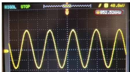
圖 7-5 範例 DAC4 輸出波形
