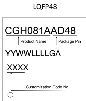
图 22.2 自定义丝印 (使用自定义代码)
