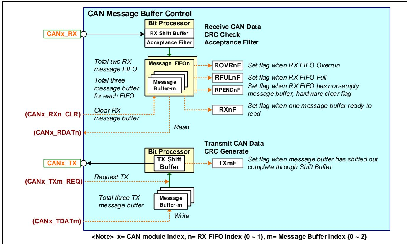
用户可通过读取 **CANx\_RDATn0**, **CANx\_RDATn1**, **CANx\_RDATn2** 和 **CANx\_RDATn3** 这四个 32 位数据寄存器，从任一 RX 消息 FIFO 获取 CAN 消息数据。同样，用户可通过向 **CANx\_TDATm0**, **CANx\_TDATm1**, **CANx\_TDATm2** 和 **CANx\_TDATm3** 这四个 32 位数据寄存器写入数据，将 CAN 消息数据输出至任一 TX 消息缓冲器。(n=RX 消息 FIFO 索引{0~1}，m=TX 消息缓冲器索引{0~2})
