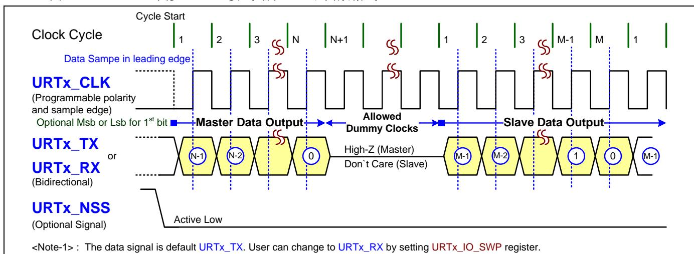
对于单线 SYNC 模式，时钟输出来自 **URTx\_CLK**，数据信号默认为 **URTx\_TX**。用户可设置 **URTx\_IO\_SWP** 寄存器改变数据信号为 **URTx\_RX**。对于数据传输，用户需使能 **URTx\_TX\_EN** 寄存器并设置 **URTx\_RX\_EN** 寄存器改变数据传输方向为发送或接收。此模式下，TCF 标志(**URTx\_TCF**)可表示上一个数据传输完成。
