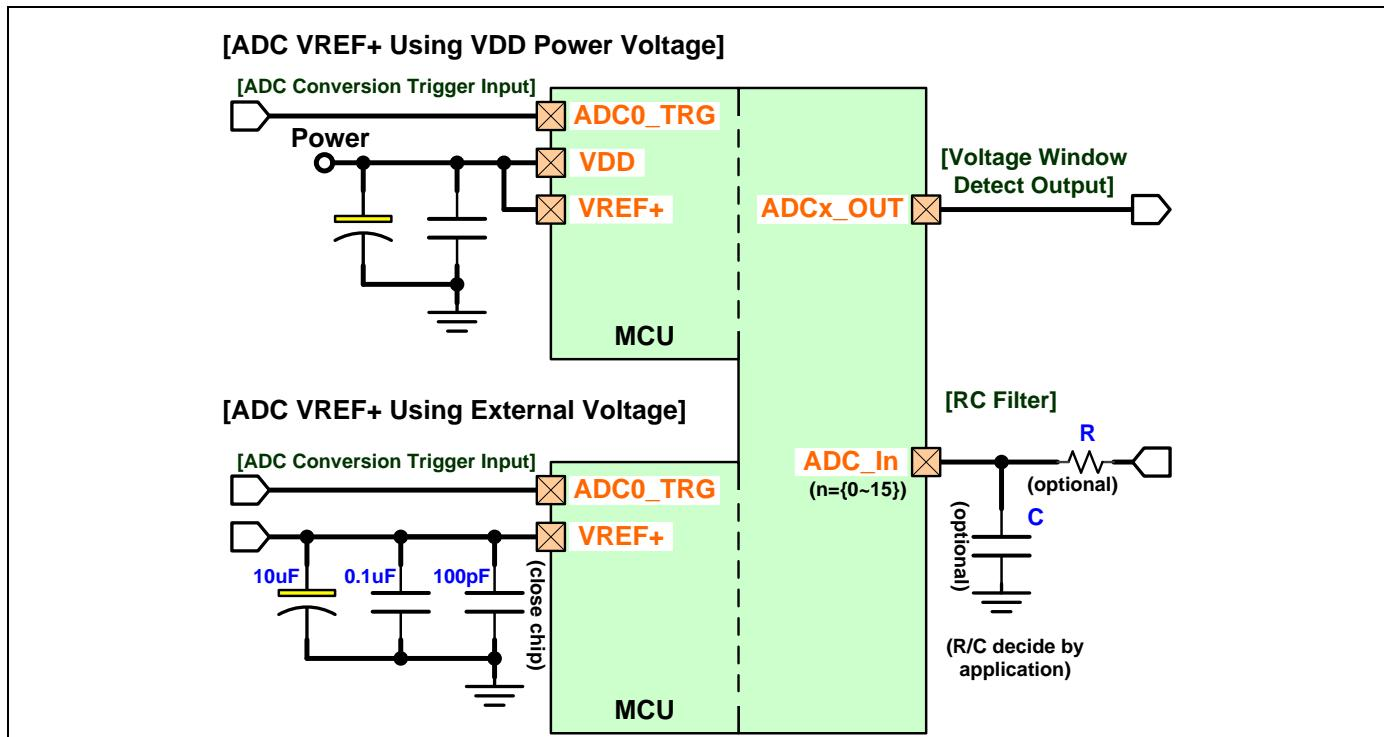
如果芯片封装没有 **VREF+** 引脚, 则 **VREF+** (ADC 参考电压) 将与 **VDD** 电源内部连接。下图显示了不带 **VREF+** 引脚的 ADC 应用电路。
