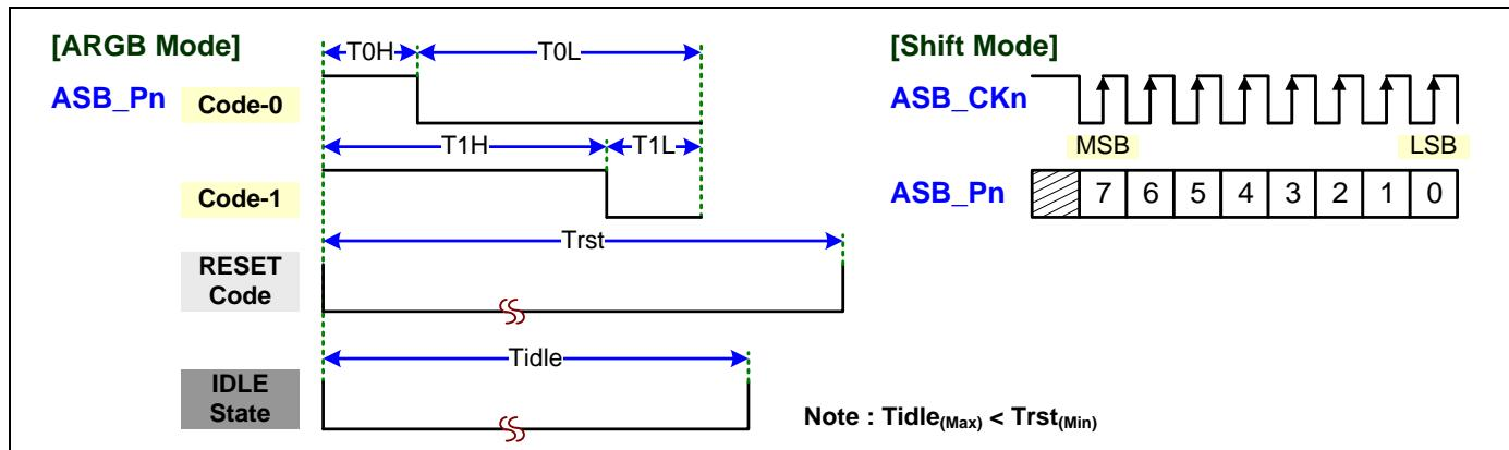
参考 ASB 块，每个通道都支持 MSB/LSB 交换和数据反转逻辑。用户可以设置 **APX\_ASFn\_MSBEN** 寄存器，以 Lsb 优先或 Msb 优先配置输出数据顺序，并通过设置 **APX\_ASFn\_DINV** 寄存器，使传输的数据位从“0”反转为“1”或从“1”反转至“0”。此外，每个通道都支持输出信号反转逻辑，用户可以设置 **APX\_ASFn\_INV** 寄存器，以通过相关的输出引脚 **ASB\_Pn** 反转输出信号，从而连接外部 ARGB 设备。
