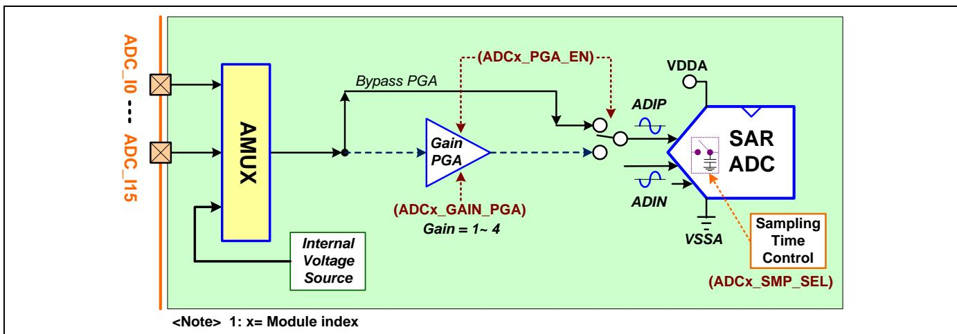
ADC 模块内建 1 个 PGA（可设置增益放大器）以加强 ADC 输入质量并放大输入电压范围。PGA 增益在测量低电平信号时有所帮助。提高 PGA 增益，可减低输入参考噪音。用户可通过 **ADCx\_PGA\_EN** 寄存器使能 PGA，通过 **ADCx\_GAIN\_PGA** 寄存器设置增益值 1 到 4。
