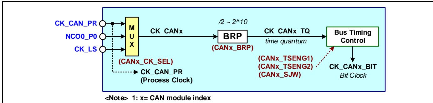
CAN 模块内置波特率发生器，输出内部时钟 **CK\_CANx\_TQ** 作为接收数据信号的时基时钟和发送数据信号的时钟源。用户可以通过设置 **CANx\_BR** 寄存器来配置波特率生成器。波特率计数器配置为 10 位计数器。
