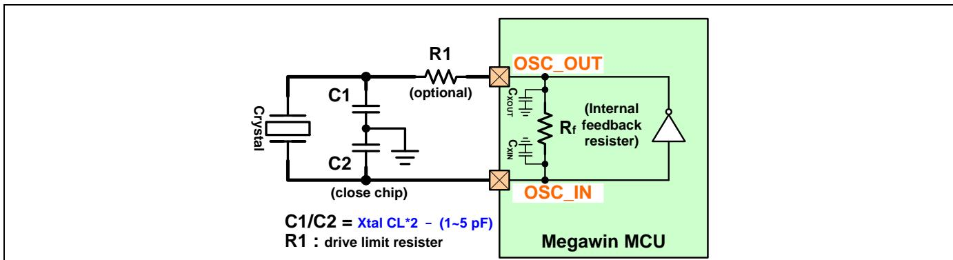
下表列出了芯片内部振荡电路、边界焊盘、边界线、引线框架的内部总等效电容（ $C_{XIN}$  /  $C_{XOUT}$ ）。电容（ $C_{XIN}$  /  $C_{XOUT}$ ）请参考相关芯片数据手册的“Xtal 振荡电路”部分。
