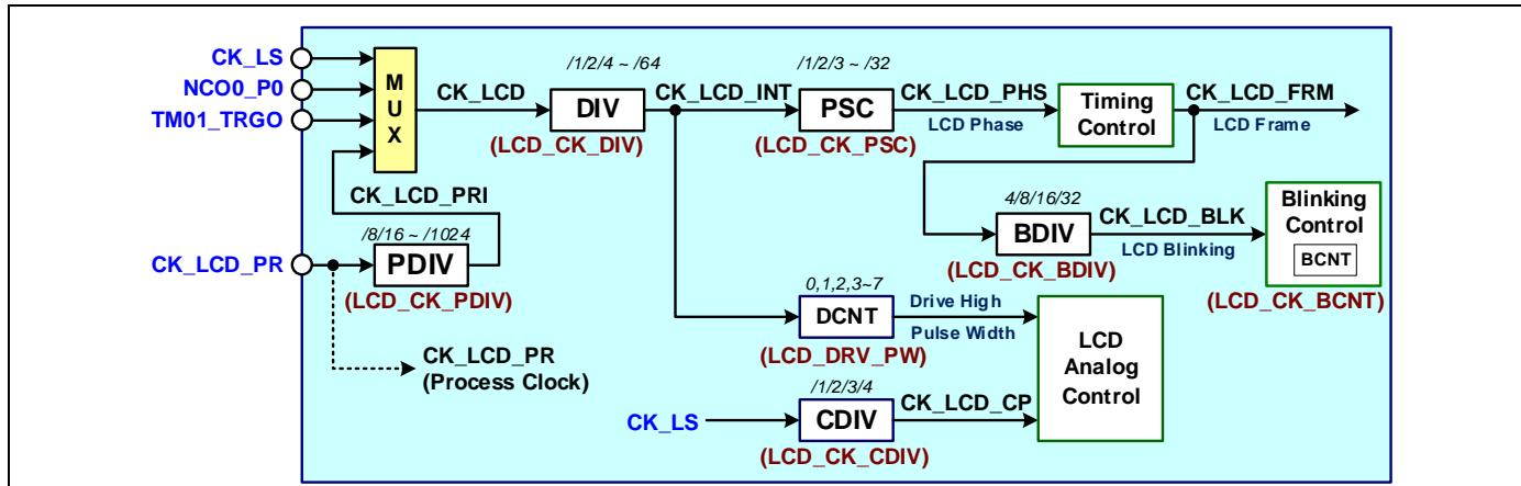
LCD 模块能够通过一个时钟分频器从 **CK\_LCD** 模块时钟生成内部时钟 **CK\_LCD\_INT**，作为 LCD 显示时序的时钟源。该分频器可通过 **LCD\_CK\_DIV** 寄存器将 **CK\_LCD** 时钟分频 1/2/4/8/~/64 倍。
