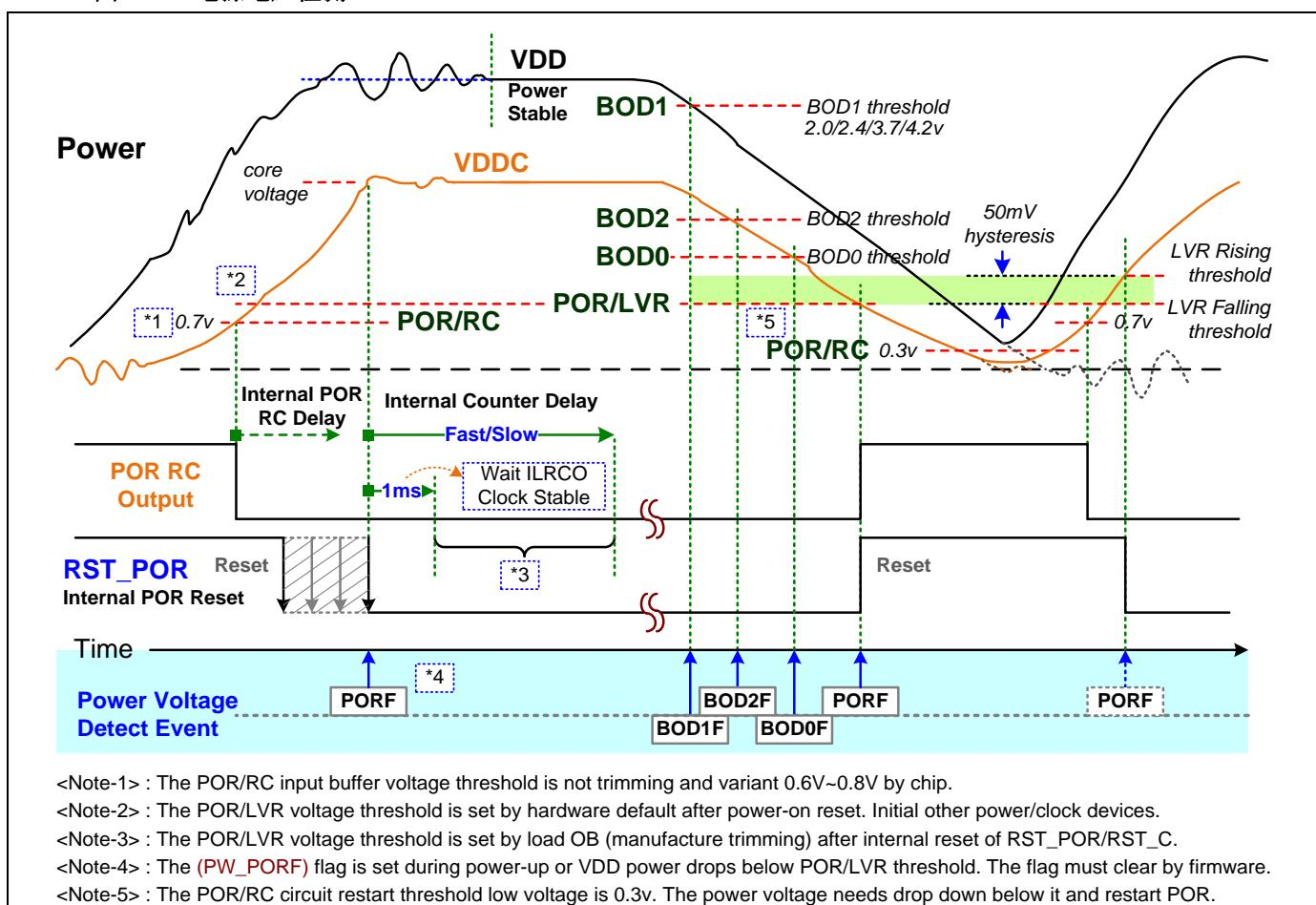
下表显示了芯片的电压检测阈值。LVR 检测阈值电压的滞后约为 50mV。
