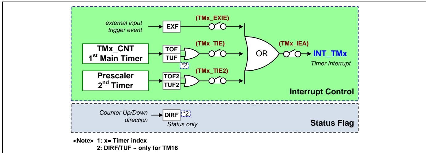
下面的图表展示了 TM2x 和 TM3x 的定时器中断控制和比较寄存器更新控制。
