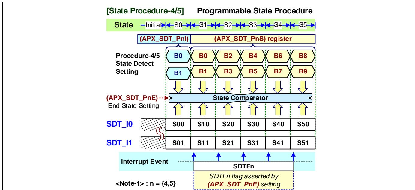
状态步骤 4,5 是两个独立可编程的步骤，它们可以通过可配置的寄存器定义检测状态流和最后状态索引。用户需要将希望的初始状态值 0/0,0 / 1,1 / 0,11 设置到 **APX\_SDT\_P4I** 或/与 **APX\_SDT\_P5I** 的初始状态寄存器中。接下来，用户可以将希望的顺序状态值 0/0,0 / 1,1 / 0,11 设置到 **APX\_SDT\_P4S** 或/与 **APX\_SDT\_P5S** 的顺序寄存器中，用于 **SDT\_IO / SDTI1** 输入检测。
