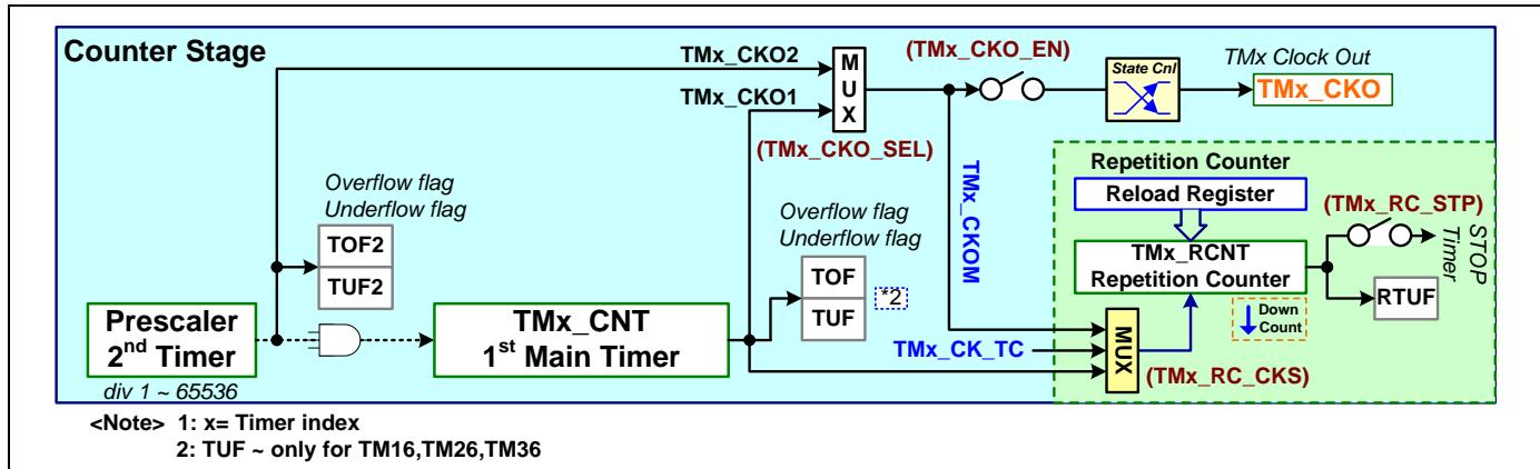
重复计数器包含了 8 位向下计数器用于 TM2x/TM3x 模块。用户可在 **TMx\_RC\_EN** 寄存器使能重复计数器。用户可通过 **TMx\_RC\_CKS** 寄存器选择计数器输入时钟源来源于主定时器上溢/下溢输出信号、**TMx\_CKOM** 脉冲信号或 **TMx\_CK\_TC** 时钟信号。**TMx\_CKOM** 脉冲信号可通过 **TMx\_CKO\_SEL** 寄存器选择来源于主定时器或 2nd 定时器的上溢/下溢输出信号。
