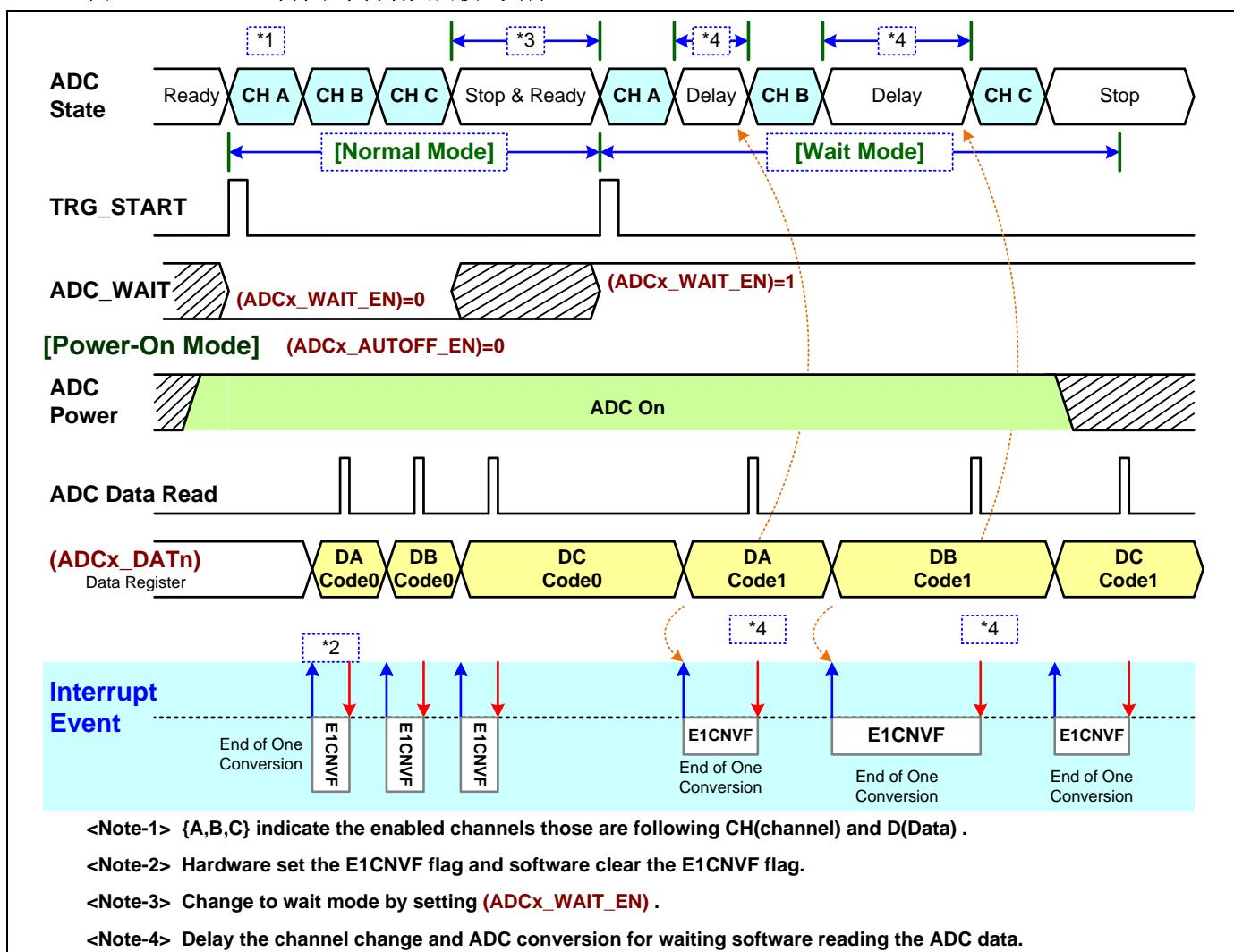
下图展示了 ADC 等待带自动关闭模式时序。ADC 模块会在 ADC 转换完成后保持关闭直到下一次 ADC 转换开始。
