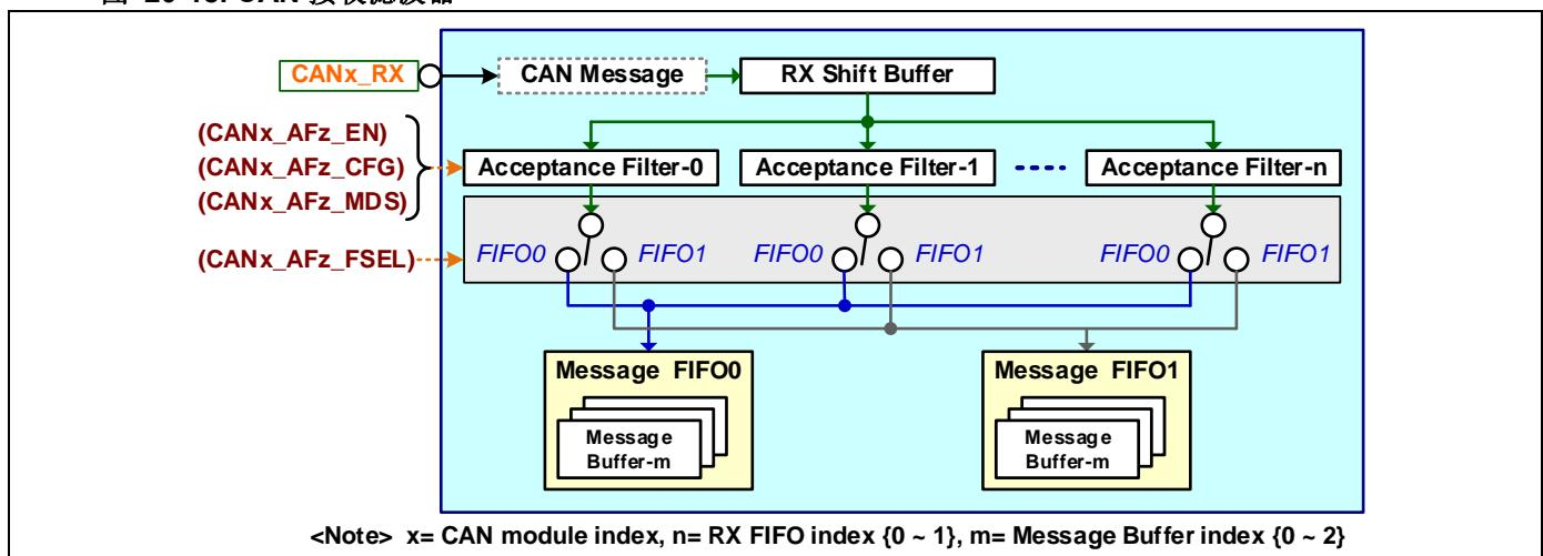
每个 RX 接收滤波器可通过设置独立的 **CANx\_AFz\_CFG** 寄存器，配置为单个 32 位滤波器或双 16 位滤波器。此外，每个 RX 接收滤波器还可通过设置独立的 **CANx\_AFz\_MDS** 寄存器，配置为“掩码（Mask）”模式或“列表（List）”模式。
