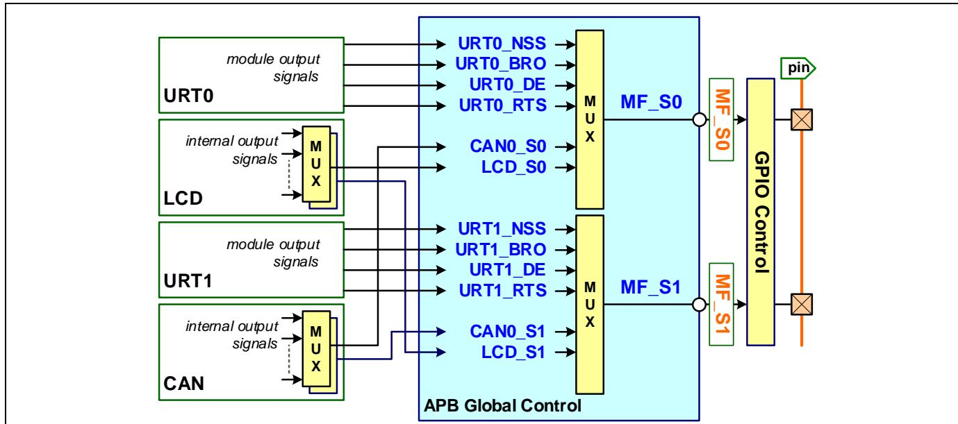
下表展示了多功能源信号。对于 MG32F02A128/U128/A064/U064，**USB\_S0** 和 **USB\_S1** 的 AFS 引脚设置与 **MF\_S0** 和 **MF\_S1** 相同。
