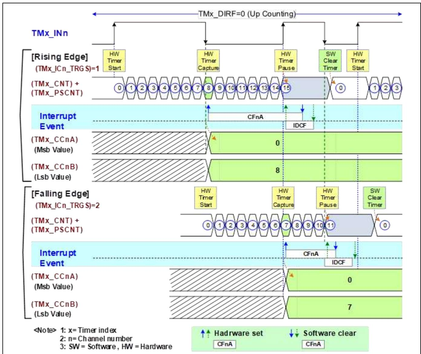
对于全计数器模式，定时器将在输入捕获信号的前沿启动，并在占空比捕获功能使能后，在输入捕获信号的后沿捕获 **TMx\_CCnA** 和 **TMx\_CCnB** 寄存器的计数器。用户可以从这些寄存器中获取捕获值来计算脉冲宽度。接下来，定时器在下一个前沿停止。用户可以从 **TMx\_CNT** 和 **TMx\_PSCNT** 的寄存器中获取主定时器和预分频器/2<sup>nd</sup> 定时器的定时计数器。所以用户可以计算输入波形的捕获周期时间和占空比。占空比周期为 **{TMx\_CCnA, TMx\_CCnB} / {TMx\_CNT, TMx\_PSCNT}**。**TMx\_CCnA** 和 **TMx\_CNT** 是 MSB。
