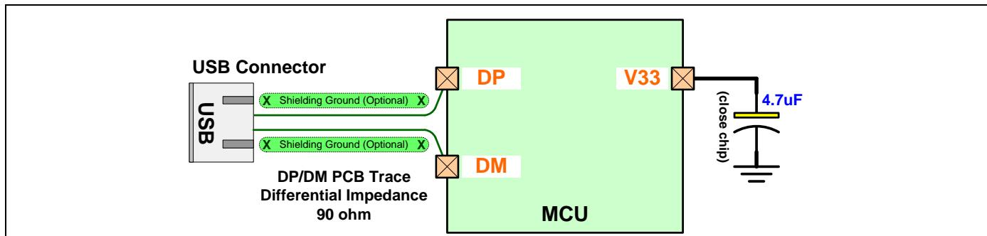
DP 和 DM 信号的布线建议按照下图的“Edge-Coupled Coated Micro-strip”或“Diff Coated Coplanar Strip with Ground”布局。下图展示了 DP 和 DM 信号在 2-layer 1.6mm FR4 PCB 建议参考。
