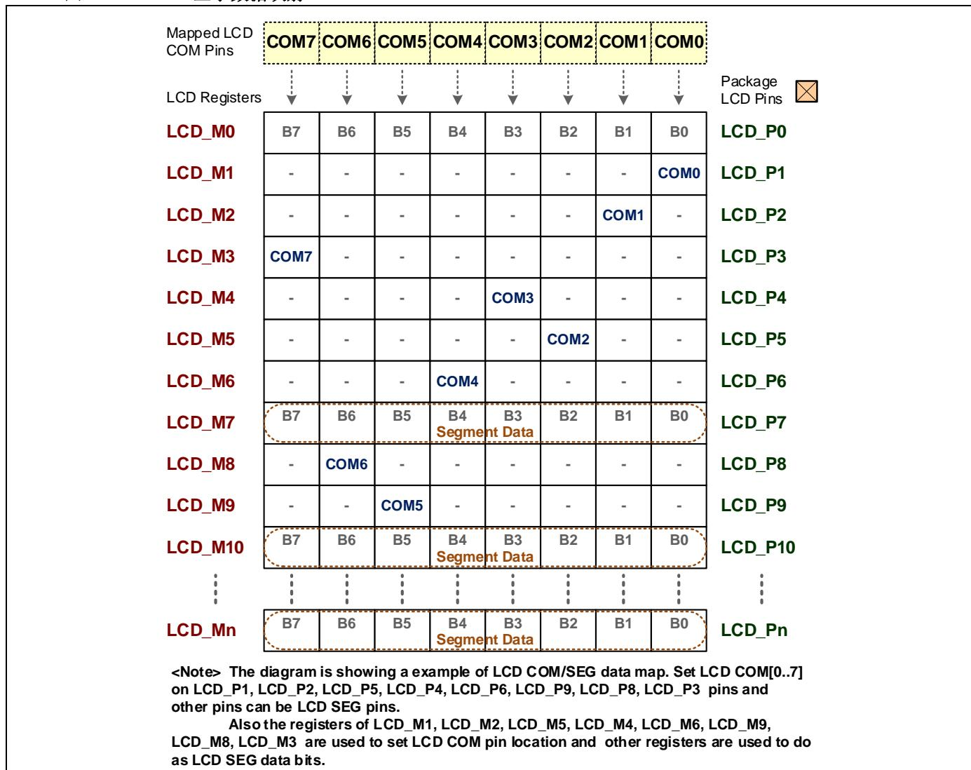
一个公共线示例，将 **LCD\_P4** 引脚分配为 COM4 公共线，需将 **LCD\_M4** 寄存器的第 3 位（bit-3）设置为 1，同时其他位必须全部置 0。另一个例子，将 **LCD\_P9** 引脚分配为 COM5 公共线，需将 **LCD\_M9** 寄存器的第 5 位（bit-5）设置为 1，同时其他位必须全部置 0。
