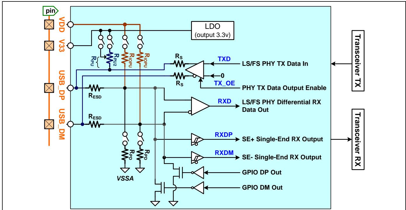
芯片在 **DP** 线路内嵌了约 1.2K 欧姆的上拉电阻(**RPU**)用于 USB 全速模式的连接。用户可在 **USB\_DPU\_EN** 寄存器使能该上拉电阻。
