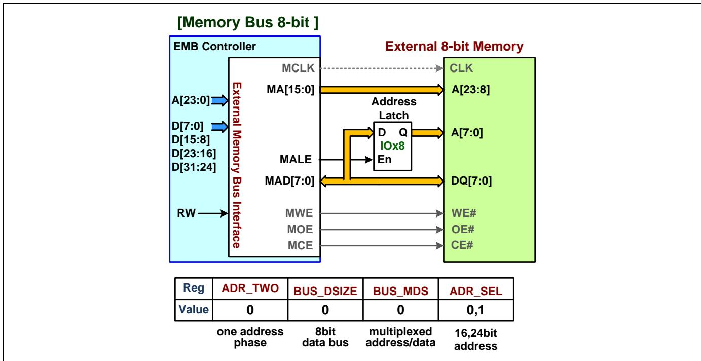
图 13-20. EMB 地址/数据时序 – 16bit MA + 8bit MAD
