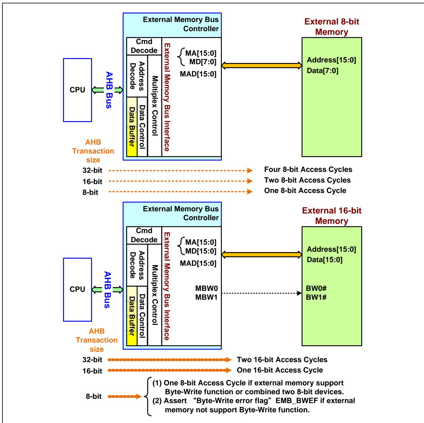
下面的表格展示了 AHB 总线和外部设备的数据传输兼容性。EMB 支持访问外部内存，如 SRAM, 8/16 位数据总线的 NOR/NAND-flash。SRAM 和 NOR-flash 支持同步和异步时序，但是 NAND-flash 只支持异步时序。
