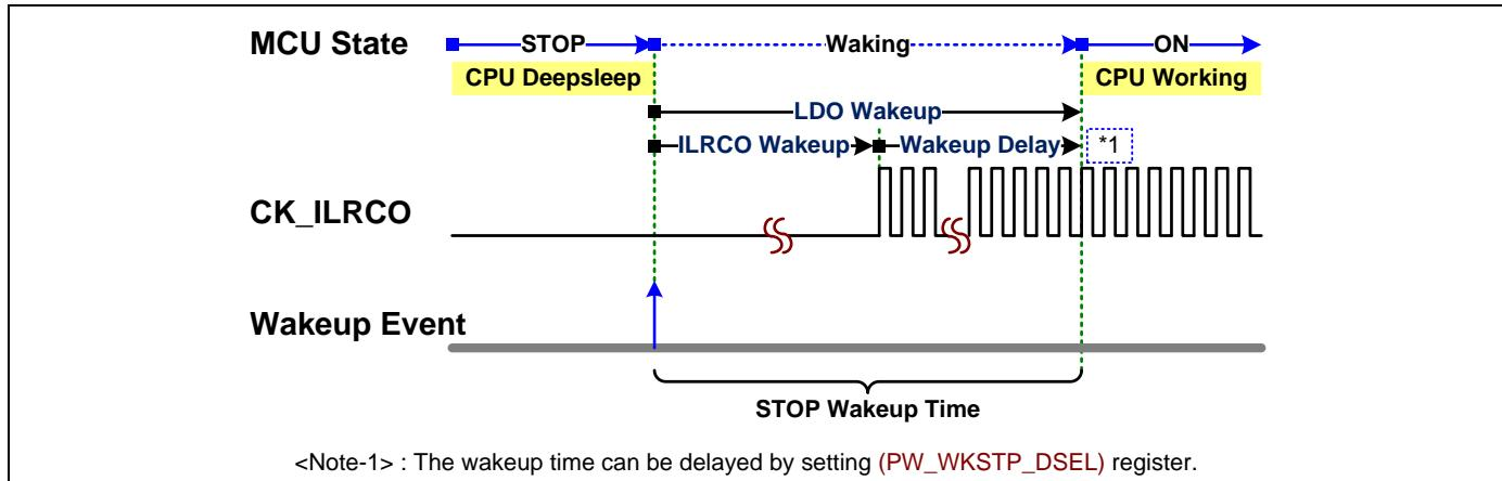
下表展示了执行 WFI 和 WFE 的 CPU 唤醒状态。参照 Cortex™-M0 技术参考手册以获取更多信息。
