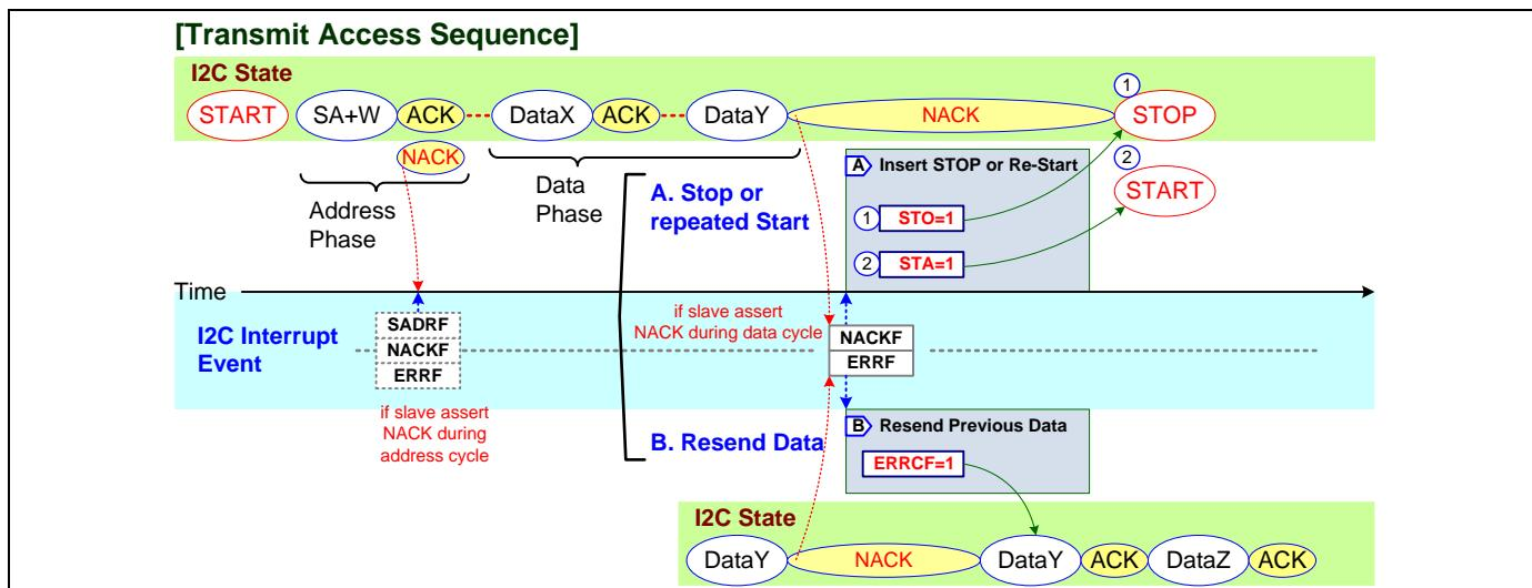
I2Cx\_TXRF 是只读状态位, 用于标识 I2C 发送数据寄存器保持状态。当 I2C 通信总线发生 NACK 错误且 I2Cx\_NACKF 已置起, 该位是用于标识数据寄存器内容是否还有数据要发送。此状态下, I2C 主机会置起 STOP。用户可通过读 I2Cx\_ACNT 寄存器计算正确的总发送数据值。I2Cx\_TXRF 位会在从机地址匹配状态清除并在最后字节 NACK 状态后更新。
