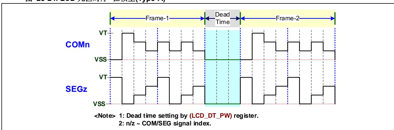
下图展示了在 Type-B 型 LCD 帧周期之间设置三个 **CK\_LCD\_PHS** (LCD 相位时钟) 周期的死区时间控制示例。
