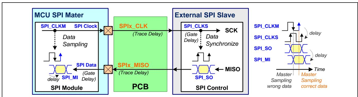
当 SPI 主机应用为高速工作或长线延迟时间，SPI 接收数据信号(**SPIx\_MISO**)可能会延迟超过 0.5T SPI 时钟(**SPIx\_CLK**)到 MCU 的 SPI 输出时钟如下图。外部 SPI 从机输入来自主机 PCB 走线和芯片门的延迟 SPI 时钟。外部 SPI 从机输出 SPI 数据会延迟到 SPI 主机。当总共两个延迟时间超过 0.5T SPI 时钟，会导致 MCU SPI 主机根据内部 SPI 时钟采样延迟的 SPI 接受数据出错。对于 SPI 主机模式，用户可通过 **SPIx\_RX\_CTL** 寄存器设置 SPI 数据采样到选择时钟的下一个边沿以得到正确数据传输。
