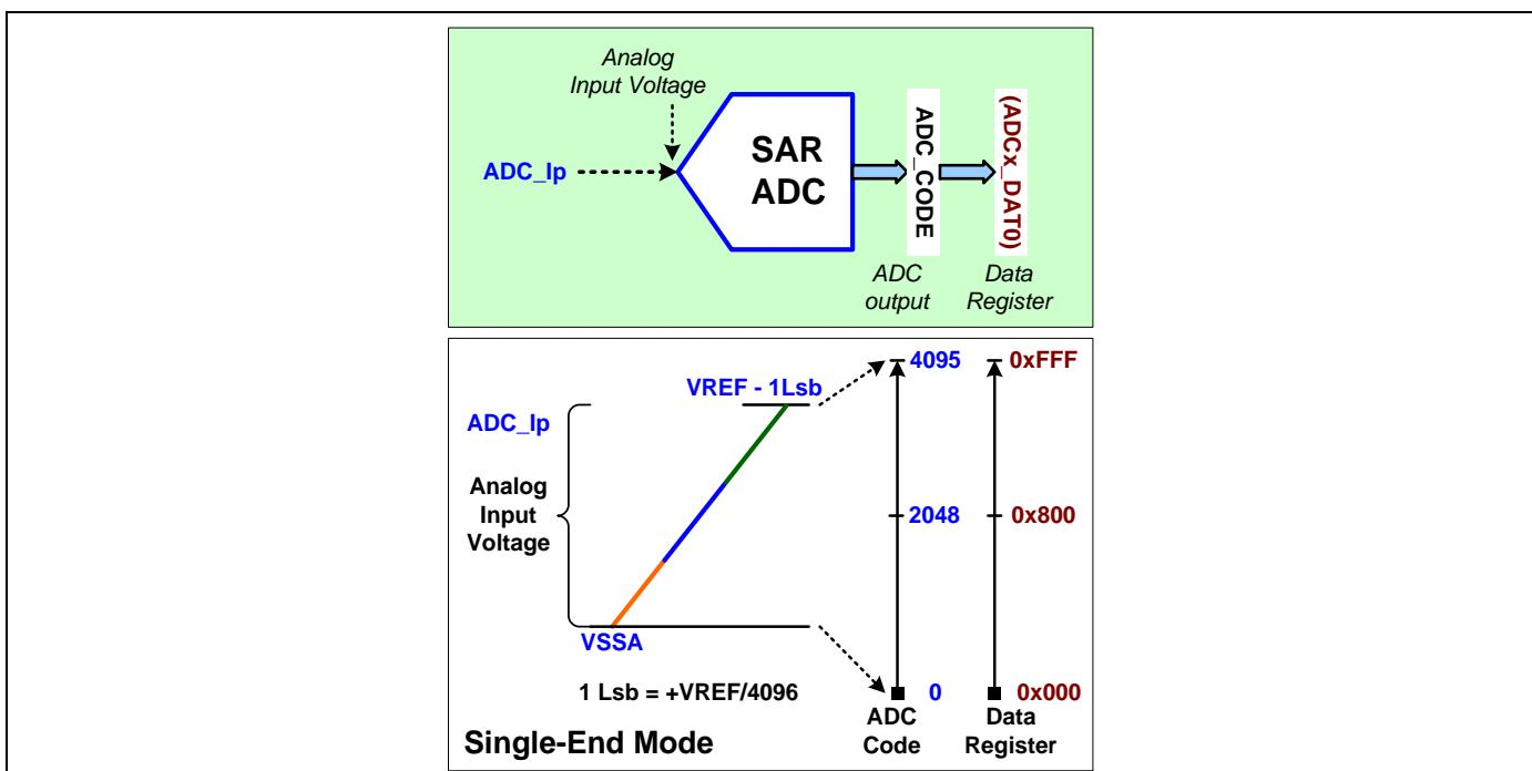
ADC 模块内嵌参考电压源 **IVR24**。用户可通过 **ADCx\_IVREF\_SEL** 寄存器选择内部 **IVR24** 电压或外部 **VREF** (**VREF+**引脚电压) 作为 ADC 参考最高电压。用户可在 **ADCx\_IVR\_EN** 寄存器使能和启动 **IVR24** 电压源。
