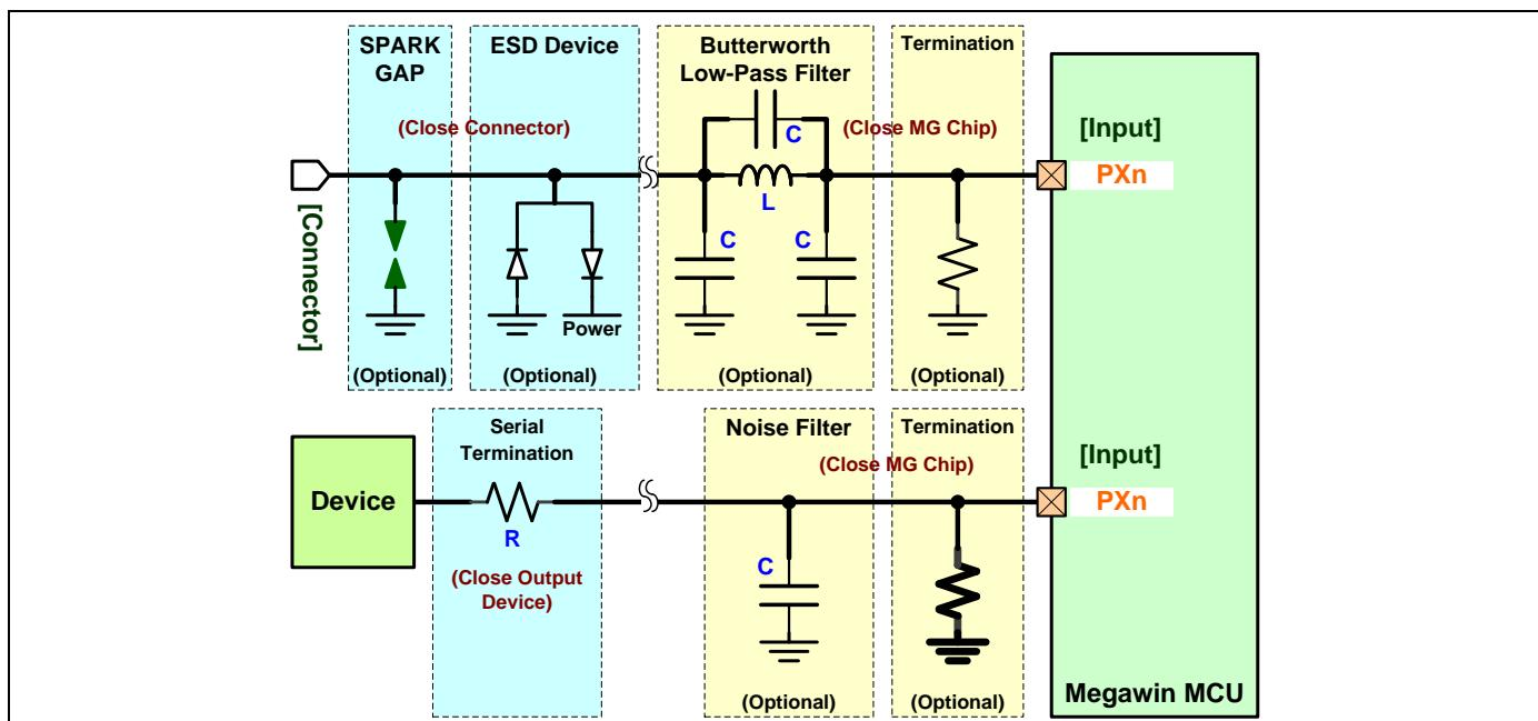
图 9-13. GPIO 输出应用电路
