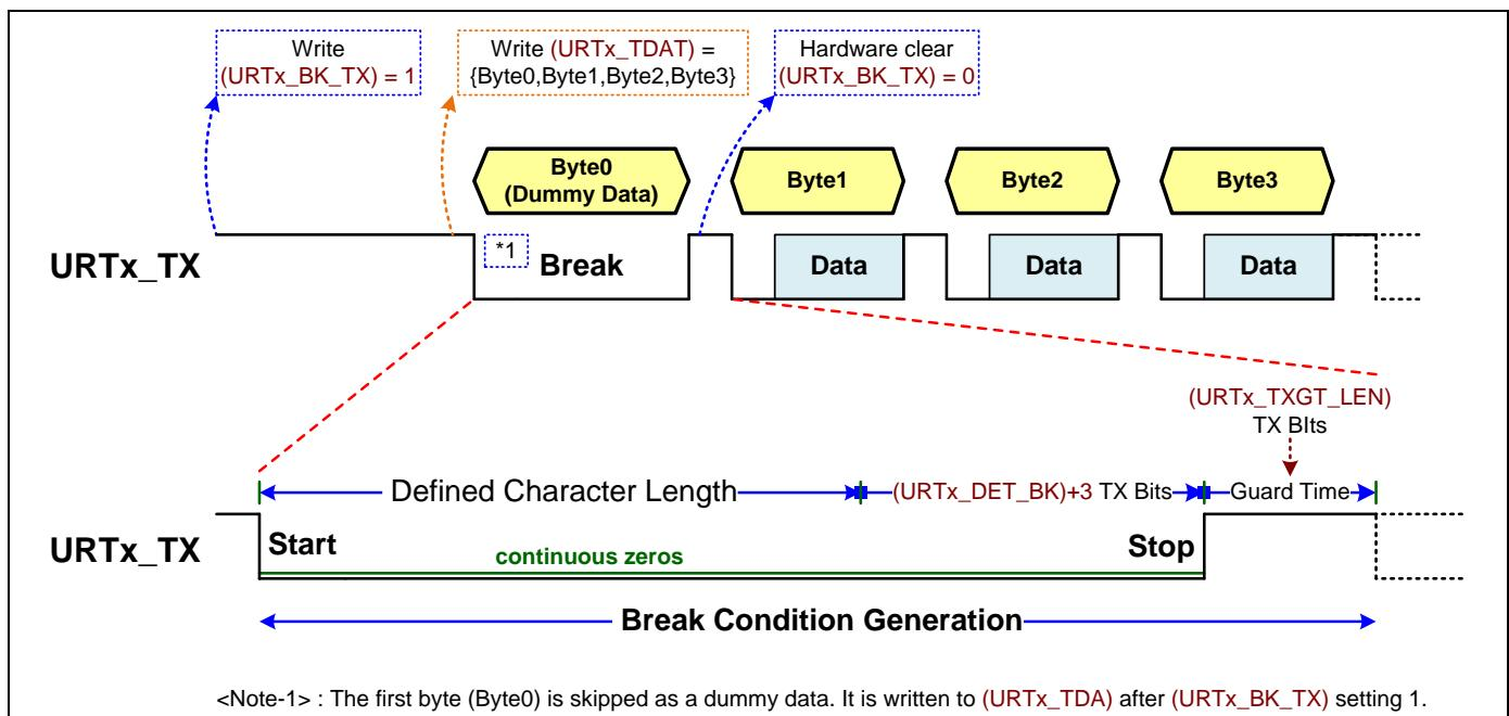
下面的表格展示了 UART 中止状态发送和检测控制设置表。
