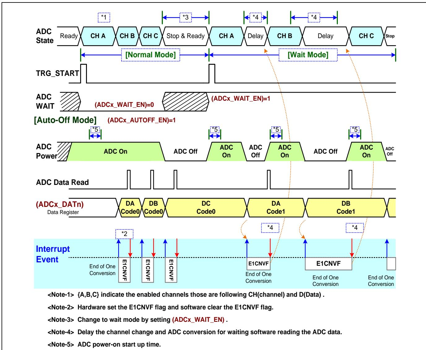
下表展示了根据 ADC 转换模式和等待模式设置下的 ADC 自动关闭模式启动周期。
