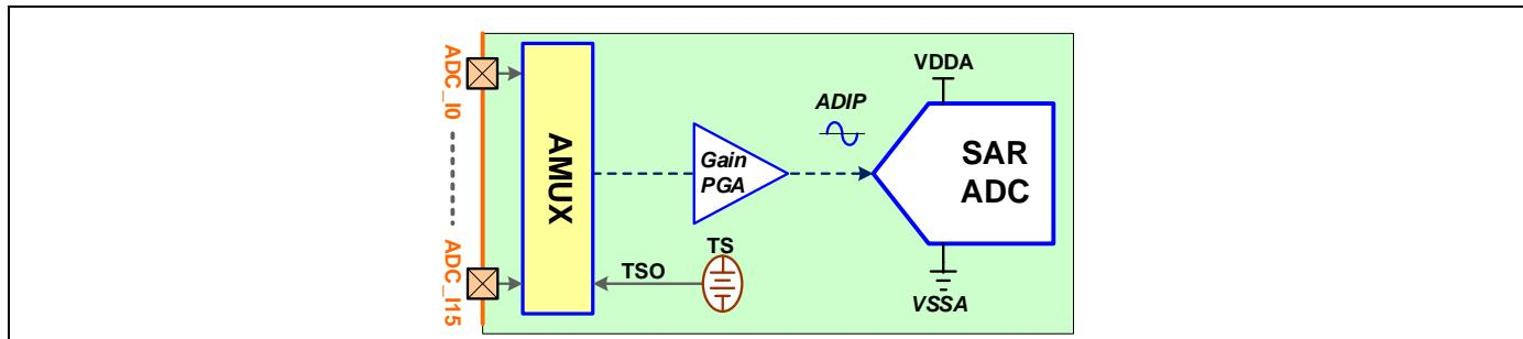
由于芯片温度是被 ADC 测量的，ADC 采样时间必须增加到超过温度传感器的使能时间，也就是 50us。参照芯片数据手册以获取关于温度传感器使能时间。
