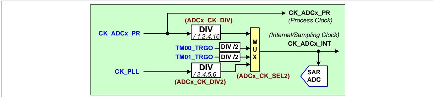
ADC 最快转换速度为 400Ksps。ADC 内部时钟或转换采样时钟可通过 **ADCx\_CK\_SEL2** 寄存器从模块工作时钟(ABH 时钟 **CK\_AHB**, APB 时钟 **CK\_APB**)、定时器触发输出信号(**TM00\_TRGO** 或 **TM01\_TRGO**)或 PLL 输出时钟 **CK\_PLL** 中选择。ADC 转换时钟不能超过 12 MHz。
