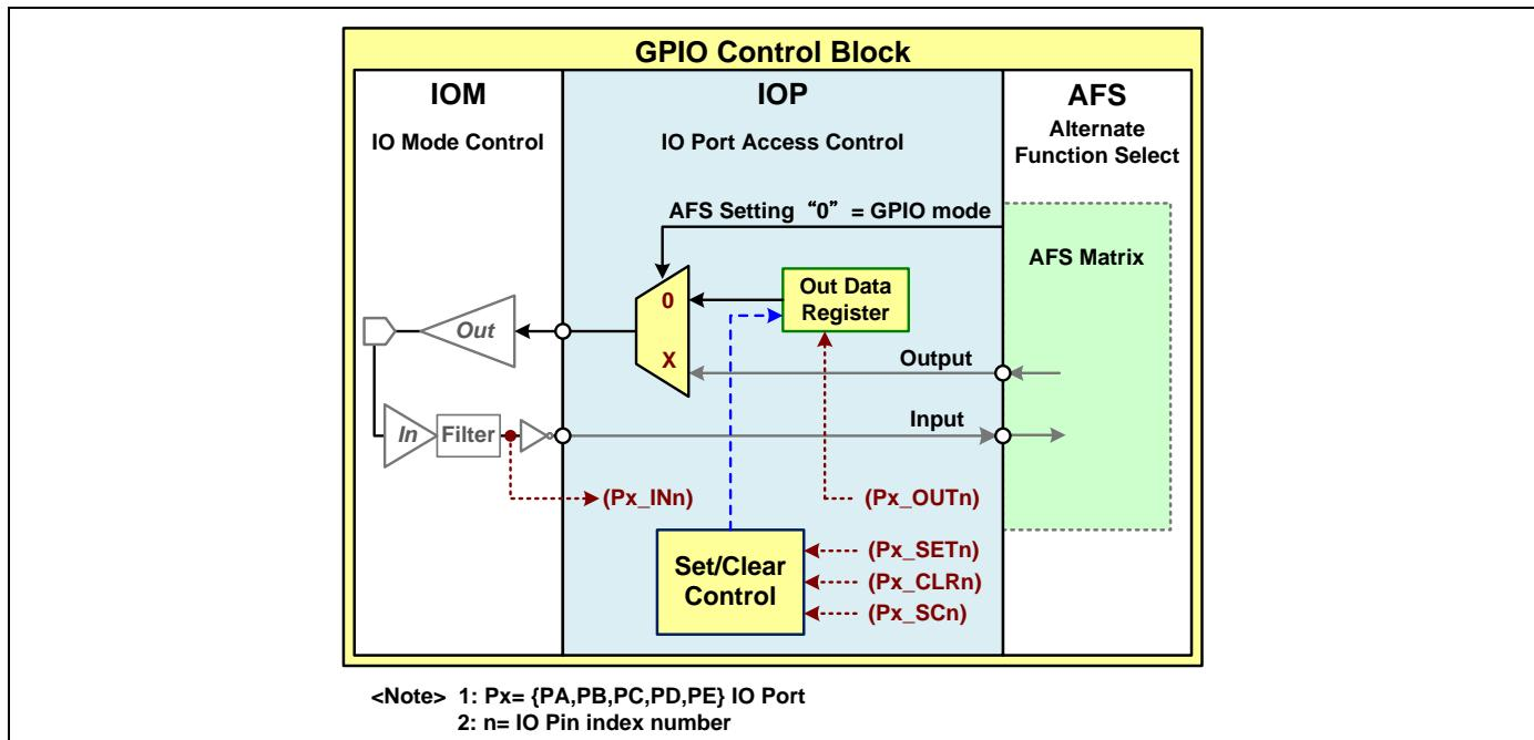
每个端口的 **Px\_OUT** 寄存器和 **Px\_IN** 寄存器是被设计用于通过 **Px\_OUTn** 和 **Px\_INn** 位读写每个 GPIO 端口的所有引脚的逻辑输出与输入。这让固件能简单地同时控制 GPIO 端口( $n=\{0\sim15\}$ )。
