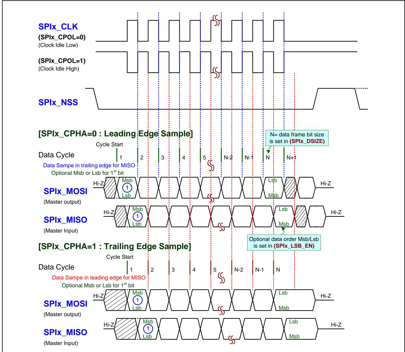
对于 SPI 从机模式，SPI 接收数据(**SPIx\_MISO**)输出时钟时序于图“[SPI 带 NSS 的基本时序](#)”相同。当 SPI 从机应用是高速且有长走线延时，也可能因为 PCB 走线和芯片门延迟导致延迟超过 0.5T SPI 时钟到外部 SPI 主机设备。在外部 SPI 主机设备的输入点，SPI 接收数据(**SPIx\_MISO**)输入时序与图“[SPI 主机高速时序](#)”类似。因此外部 SPI 数据设备必须采样输入 SPI 数据(**SPIx\_MISO**)为正常选择时钟沿的下一个边沿才能获得正确的 SPI 数据传输。
