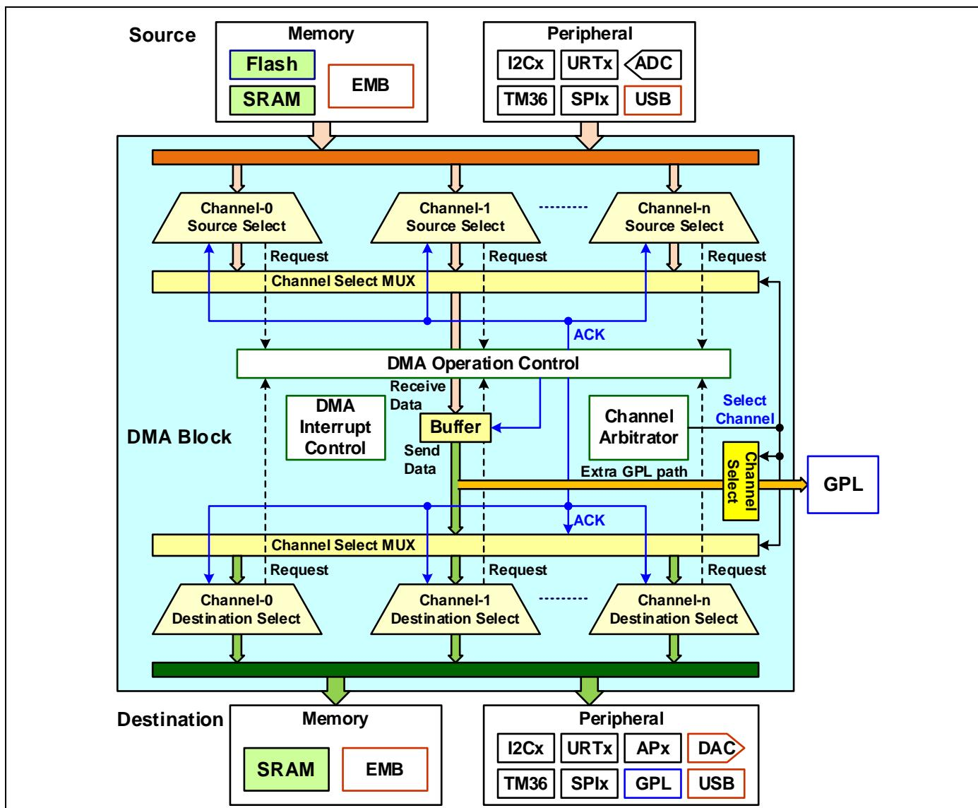
内存包含内嵌 FLASH、SRAM、EMB 访问内存空间。外设包含 ADC0, DAC, I2Cx, URTx, SPIx, TM36 和 GPL 模块。ADC 模块只能作为 DMA 源。DAC 和 GPL 只能作为 DMA 目的地。
