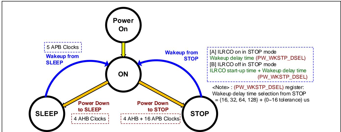
通常，ILRCO 启动时间为 2~30us。参考节“[芯片电源模式控制](#)”和“[唤醒控制](#)”以获取更多关于掉电控制和唤醒控制信息。
