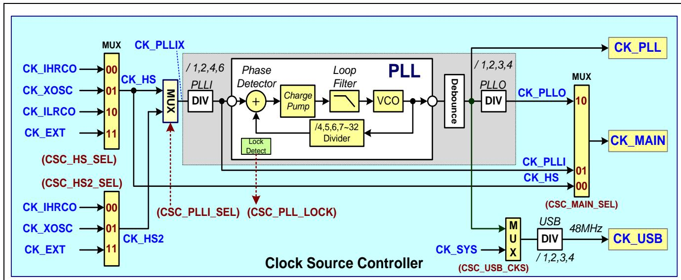
时钟输入倍频器选择时钟源 **CK\_HS** 或 **CK\_HS2** 用于 PLL 输入时钟 **CK\_PLLIX**。用户可在 **CSC\_PLLI\_SEL** 寄存器选择时钟源。PLL 输入频率范围是 4~8MHz，所以用户必须通过 **CSC\_PLLI\_DIV** 寄存器设定有效的分频值将频率分频。并输出时钟 **CK\_PLL** 最高 144-MHz 的频率。有关 PLL VCO 频率信息，请参阅相关芯片数据手册的“PLL 特性”。
