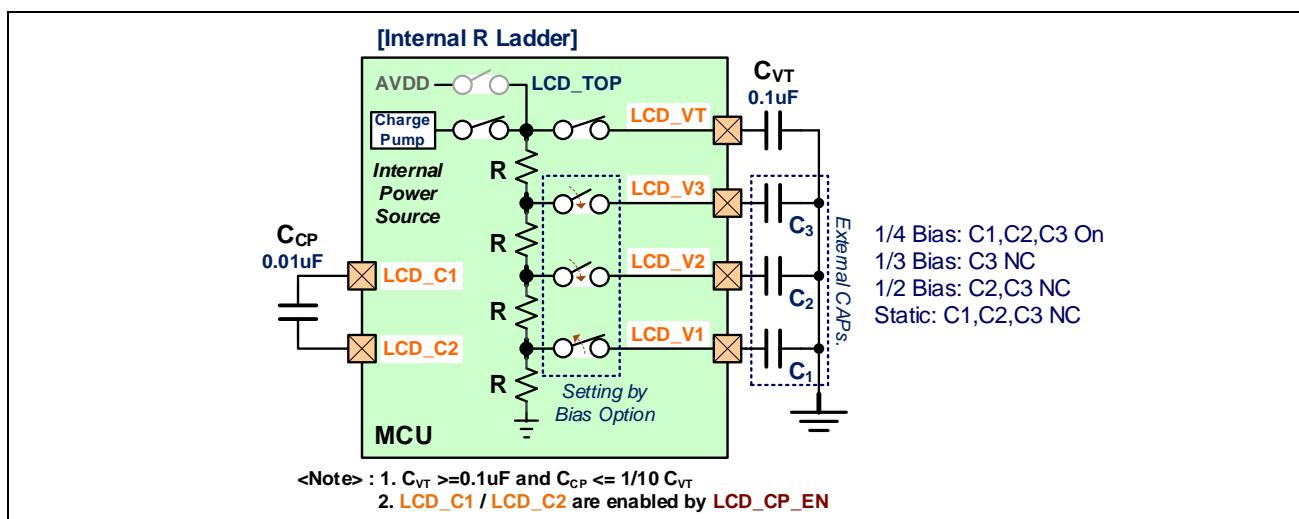
在使用内部电荷泵时，有一个硬件状态位(**LCD\_PRDYF**)和一个中断标志位(**LCD\_CPRF**)用于指示电源是否就绪。当用户首次通过 **LCD\_VS\_SEL** 寄存器切换至内部电荷泵供电模式，或从掉电模式唤醒后，可以直接读取 **LCD\_PRDYF** 状态位来检查电源电压是否稳定。
