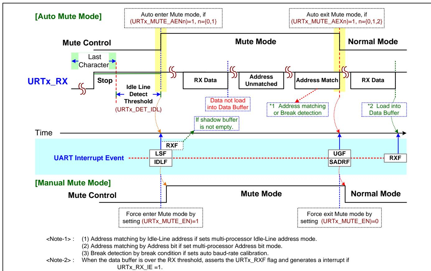
下面的表格展示了 UART 多处理器地址匹配或不匹配状态的静音模式控制。URTx\_MUTE\_EN 寄存器会根据这些状态被硬件设置。
