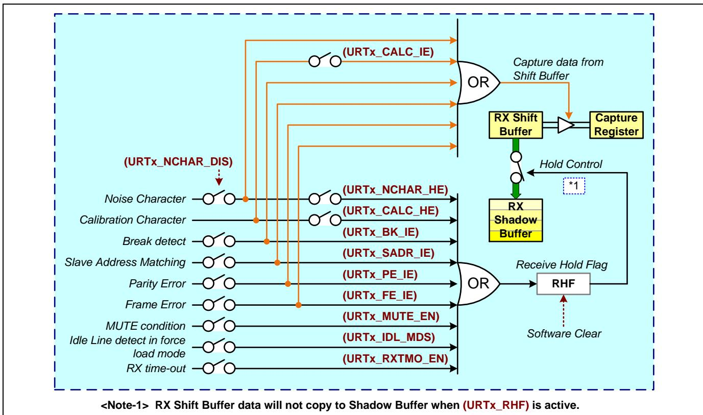
下面的表格展示了当多处理器地址不匹配时阴影缓冲和 RX 数据寄存器的 RHF 状态。RHF 会被硬件设置用于中止控制。请参照“[UART 多处理器](#)”和“[UART 静音模式控制](#)”节以获取更多关于多处理器模式的信息。
