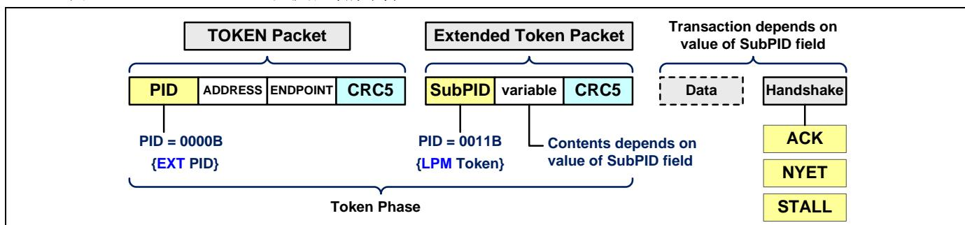
对于 LPM 事务，有两个重要的信息字段定义在 LPM 令牌 **bmAttributes** 字段中，并从主机发送到设备。第一个是 **HIRD** (或 **BESL**)，它是 USB 主机启动恢复时间。在主机启动恢复，主机驱动特定时间周期(**HIRD**)的恢复信号。主机可以选择 **HIRD** 中的持续时间，这是一个 4 位编码值，线性转换为 50 微秒到 1.2 毫秒的范围。关于 **HIRD**，有一个值成为尽力服务延迟(**BESL**)可代替 **HIRD** 的概念并重定义以表示 125us 到 10ms 的范围。
