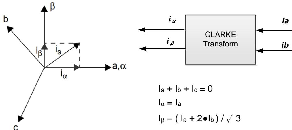
Figure 25.2.2 : Cleake Transform
