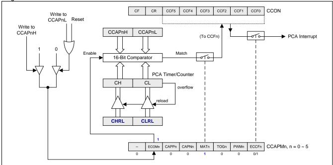
Figure 16-7. PCA0 Software Timer Mode
